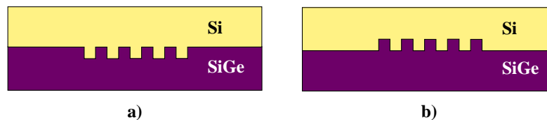
Abbildung 3.2: Varianten zur Realisierung optischer Gitter zwischen zwei Halbleiterschichten.
