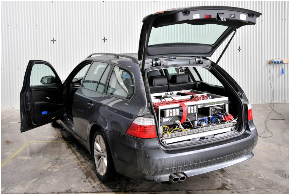
Abbildung 27: FAS-Car mit Meßtechnik für die WIM-Versuchsreihe
