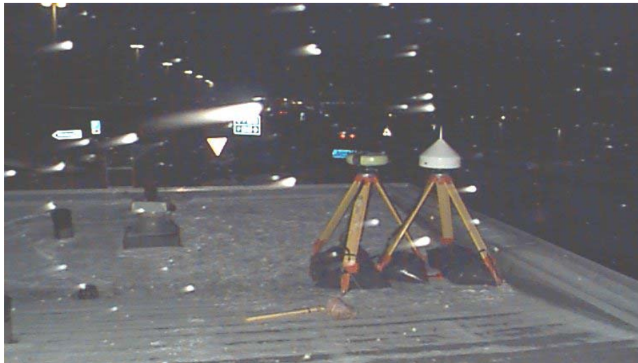
Bild 9.20: GPS-Antennen an der Masterstation auf dem Dach der Tankstelle
