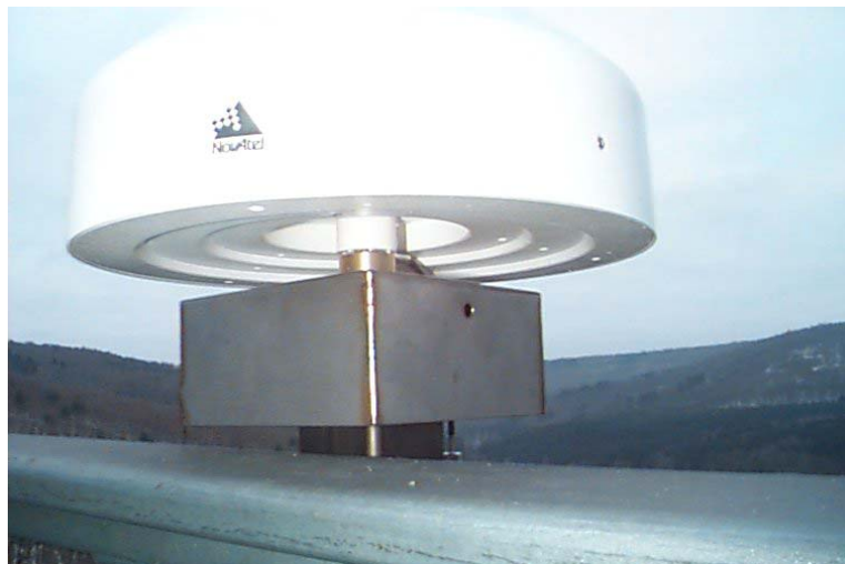
Bild 9.8: Abdeckkappe zur Sicherung der DreifüÙe gegen Dejustierung durch Dritte
