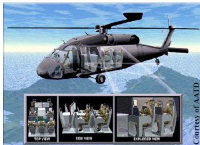
**Abbildung 8** Das Army Airborne Command and Control System (A2C2S) im Blackhawk [Gerken et al., 2003]
