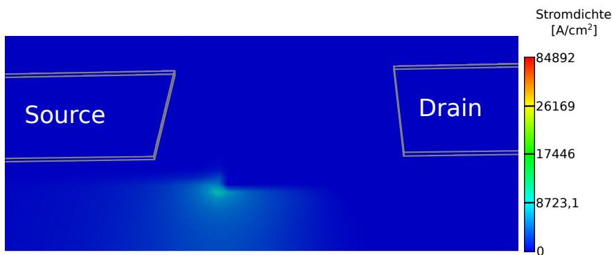
(b) Simulierte Leitungsstromdichte 200 nm unterhalb der Oberfläche.
