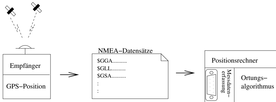
Abbildung 2.10: Schnittstelle für GPS-Position
