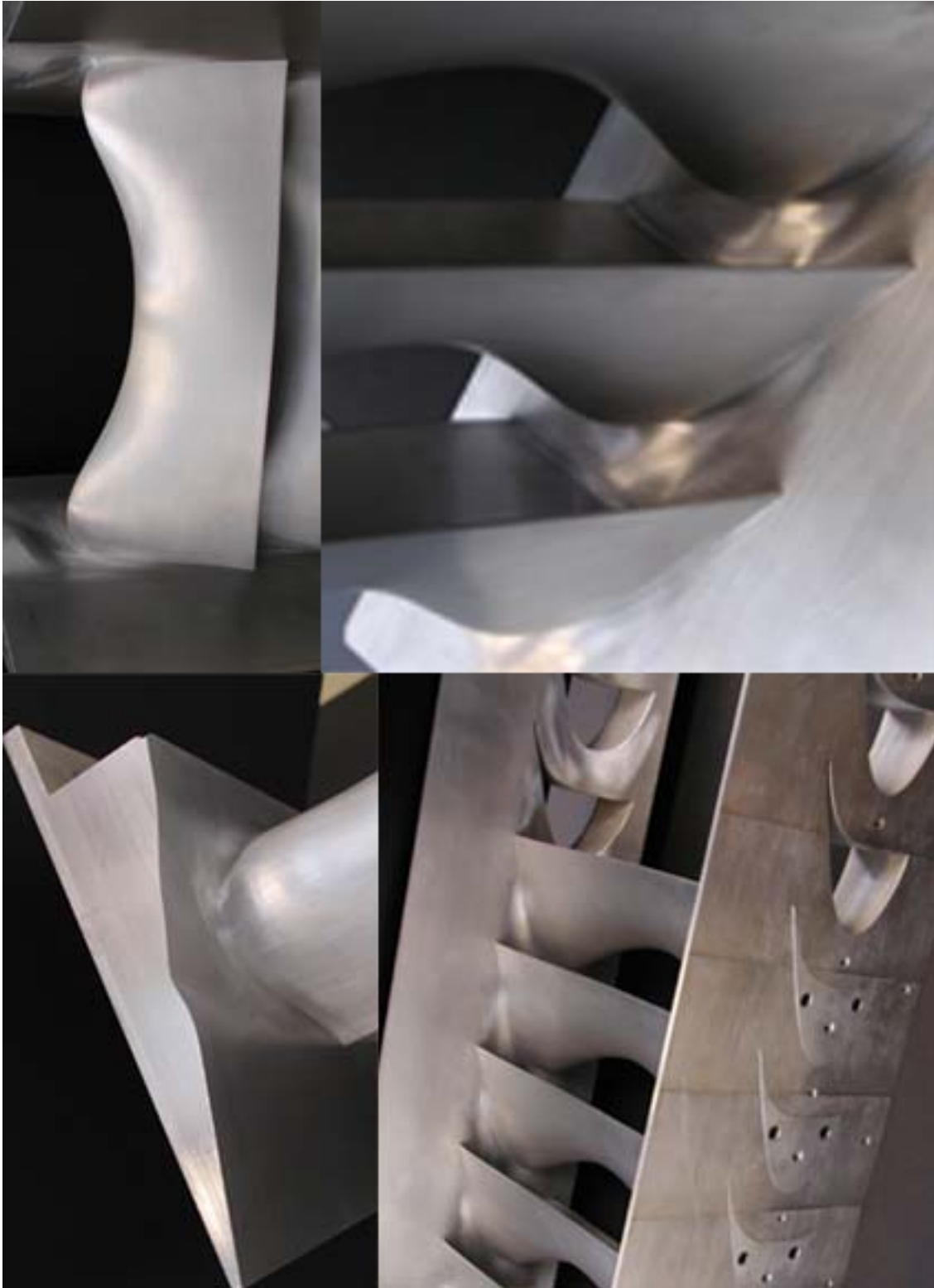
Abb. 6.5: Gefertigtes Windkanalgitter T106Dopt
