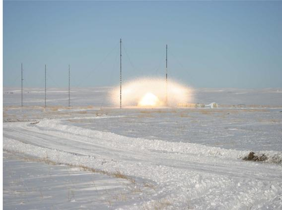
**Abbildung 1.1:** Detonation eines mit Zirconium-Partikeln versetzten Explosivmittels
