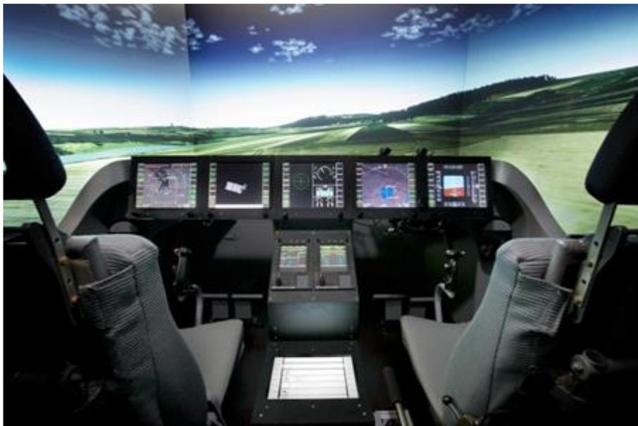
*Abbildung 5-2: Helikoptersimulator des Instituts für Flugsysteme*
