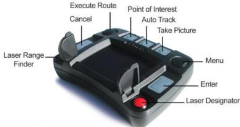
Abbildung 2-8: Bediengerät für die Führung eines UAVs aus dem Helikopter mit MUM-TK nach [Kutta Technologies 2012]
