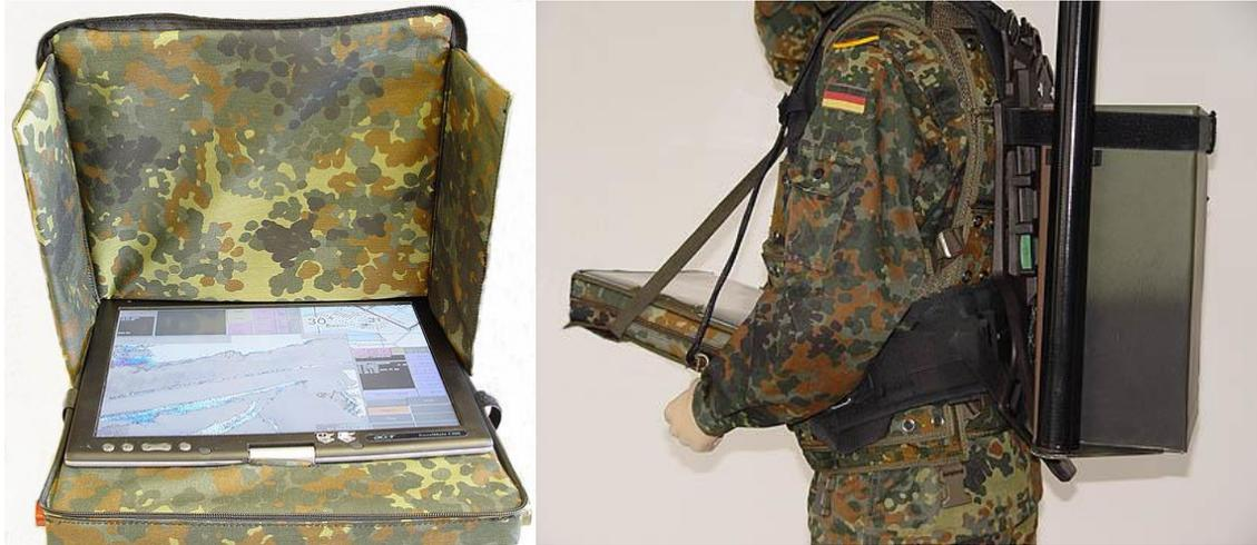
Abbildung 2-3: Tragbare Bodenkontrollstation des Systems Aladin [EMT 2012]
