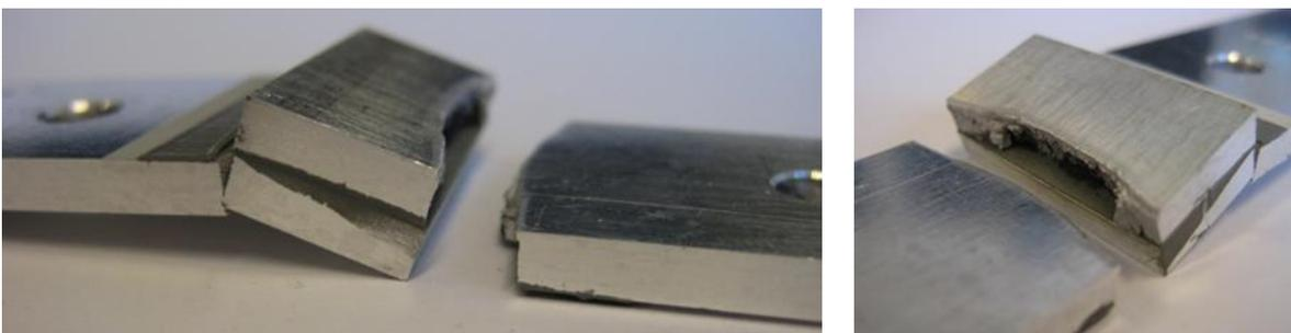
**Abbildung 75:** Aluminium-Fügeteilbruch unter zyklischer Beanspruchung
