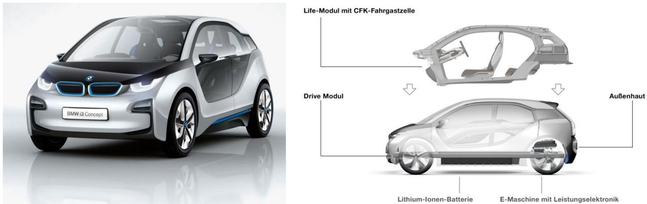
**Abbildung 2:** BMW i30; Elektromobil auf dem Weg in die Serienproduktion mit einer CFK-Fahrgastzelle (Life-Modul) und einem Drive-Modul auf Aluminium-Basis zur Unterbringung von Antriebs-, Fahrwerks und Aufprallkomponenten sowie der notwendigen Energiespeicher (BMW Group 2011)
