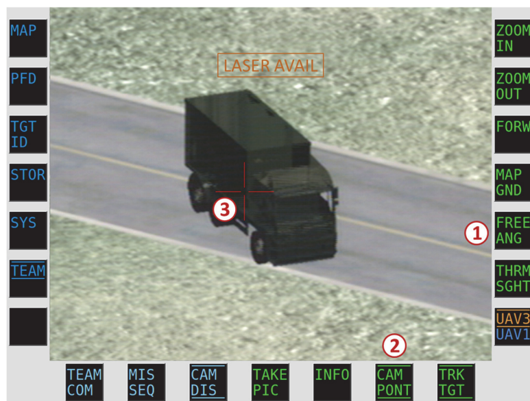
Abbildung 77: MHDD-Page zur Anzeige sowie Steuerung der von den unbemannten Teammitgliedern mitgeführten Kamerasensoren
