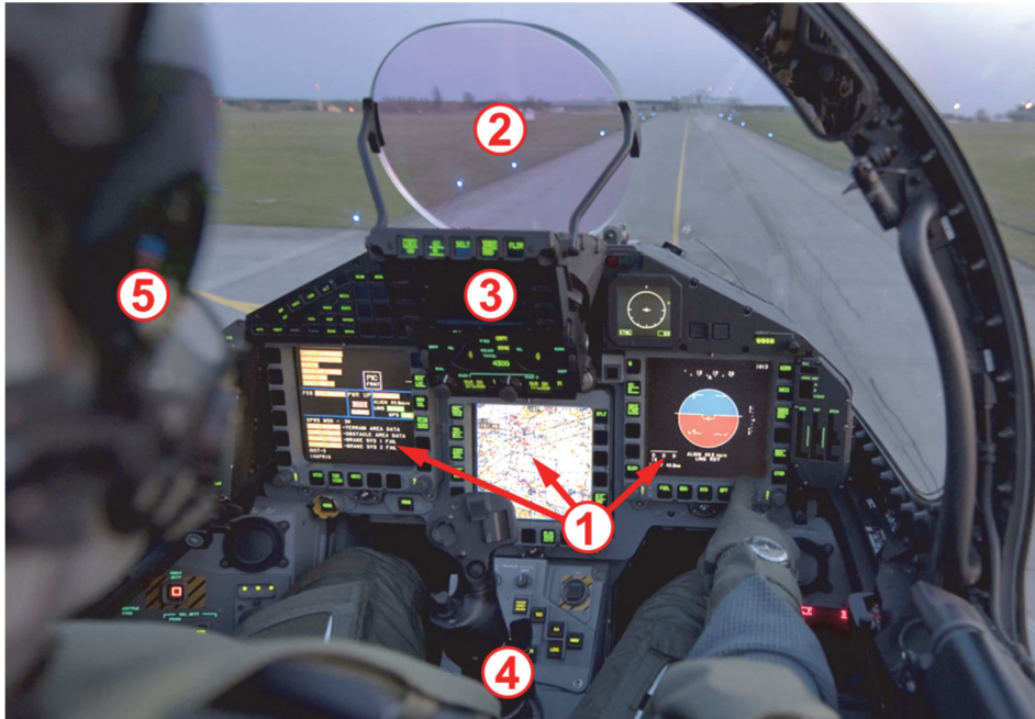
Abbildung 49: Interaktionselemente im Cockpit am Beispiel „Eurofighter“ (© Eurofighter Jagdflugzeug GmbH)
