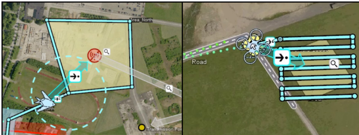
Abbildung 5-20: Individuelle Umsetzung von Mustern zur Gebietsaufklärung für die UAV-Demonstratoren Explorer (links) und OktoXL (rechts)
