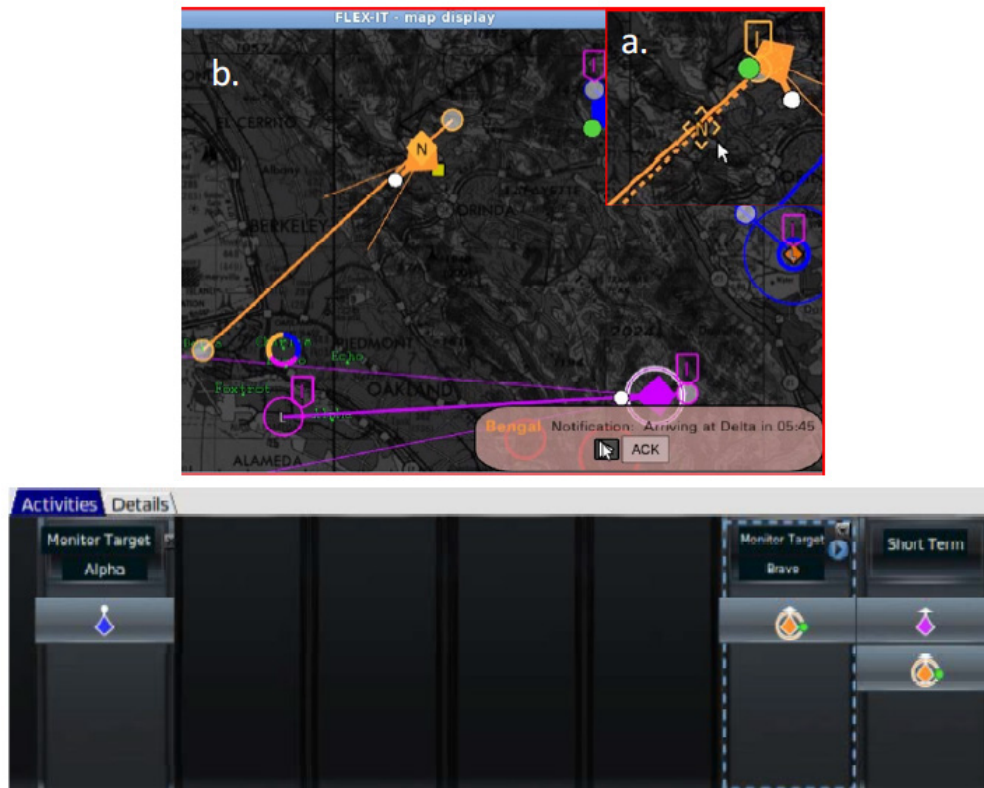
Abbildung 2-11: FLEX-IT Karten- und Aktivitätsdarstellung zur adaptierbaren Steuerung von multi-UAV [Miller 2014a]
