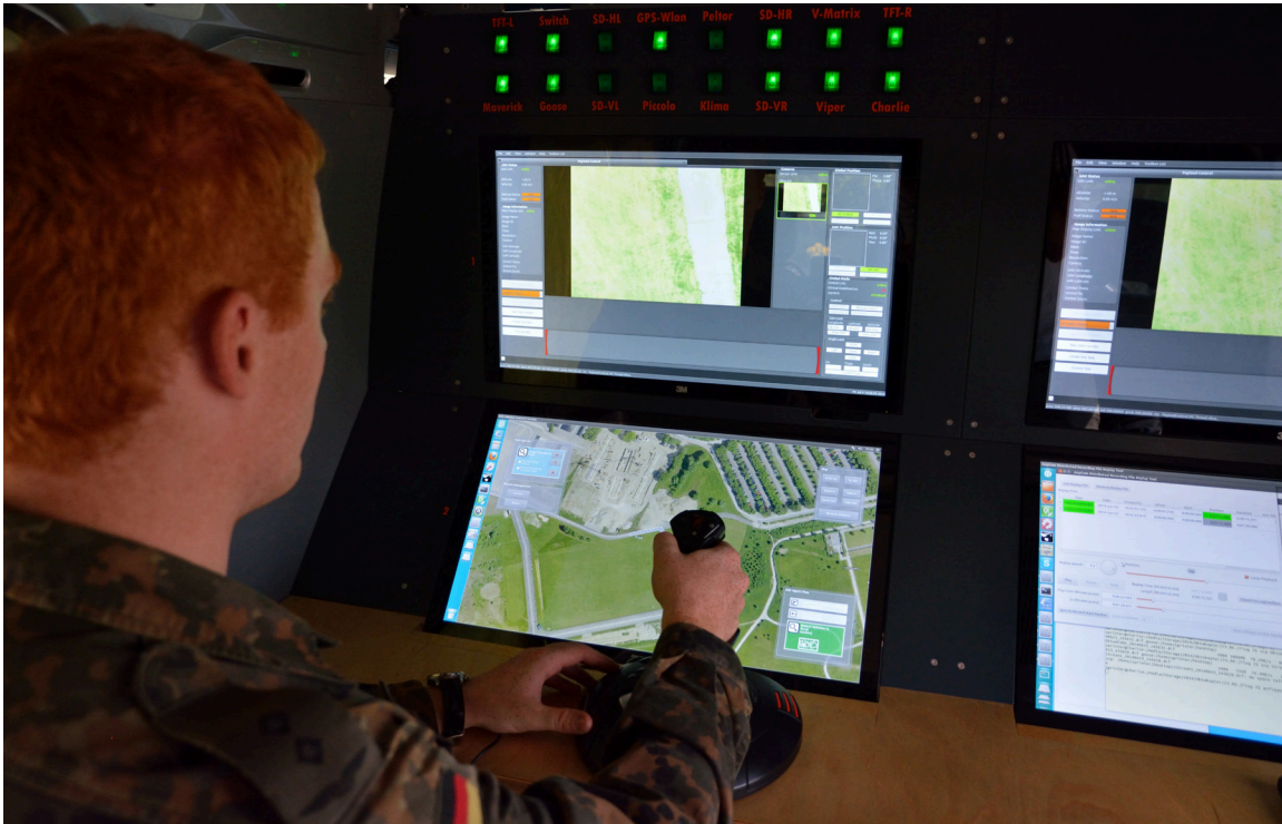
Abbildung 5-15: Mobile Bodenkontrollstation (mBKS) mit den Arbeitsplätzen für den Bediener (links) und den Experimentator (rechts). Mittels Joystick steuert der Operateur den Bildausschnitt auf dem Sensorinterface (oben)
