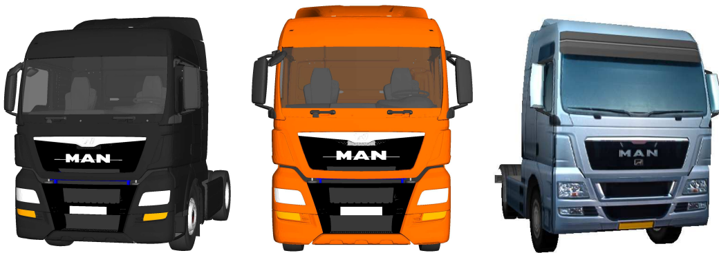
Abbildung 4.1. – Grafische Animation der drei Modelle zur Simulation der Fahrerdynamik: Nicht-echtzeitfähiges Mehrkörpermodell (links), echtzeitfähiges Mehrkörpermodell (mitte) und systemdynamisches Modell (rechts).
