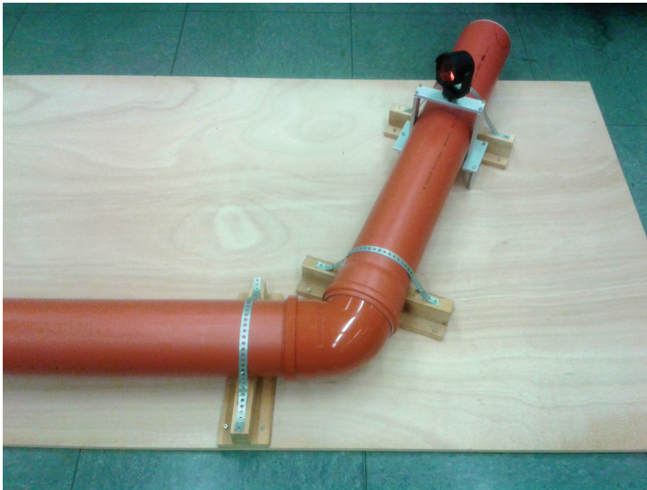
Abbildung 8.3: Tachymetrische Einmessung des fixierten Rohrsystems.
