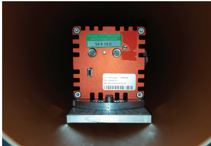
Abbildung 8.4: Schlitten mit montierter ToF-Kamera bei den Versuchen zur Bestimmung der Bogenwinkel.
