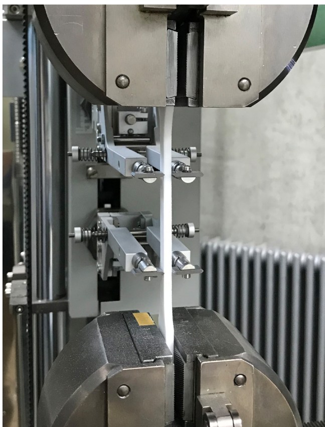
Figure 2. Specimen holder with sensor arm extensometer. Bild 2. Probenhalter mit Fühler-Extensometer.
