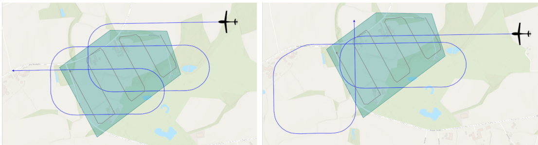
Abbildung 6.21: Sensormodellbestimmte Befliegungsplanung für das Flächenaufklärungsszenario mit DP-optimierter Referenztrajektorie (blaue Linie). Der Sensorfootprintpfad ist als dunkelgrüne Linie eingezeichnet und die global optimale Startposition ist durch das UAV-Symbol markiert. Links ist die Referenztrajektorie für das Sensorleistungsmodell YOLO-SLM und rechts für das Leistungsmodell CC-SLM dargestellt.
