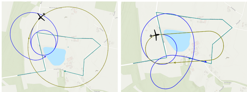
Abbildung 6.9: Trajektorienoptimierung für das Routenaufklärungsszenario mit dem Sensorleistungsmodell CC-SLM. Die blaue Linie zeigt die NMPC-optimierte Referenztrajektorie und die hellgrüne Linie repräsentiert die Benchmark-Trajektorie. Im linken Bild ist die Benchmark-Trajektorie mit Kreisbahnmuster und rechts mit Rennbahnmuster abgebildet.
