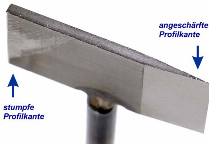
Abb. 32: Prüfling für Aufheizversuch
