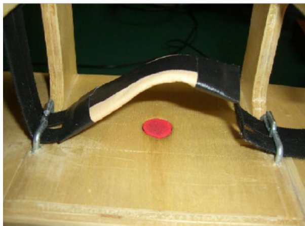
ABBILDUNG 4.23. Einspannvorrichtung für den Finger am Holzhaus für die feste Kopplung zwischen Finger und Beschleunigungsnehmer.
