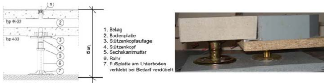
Abbildung 4.7.: Bodensystem Mero Typ 4 (geändert) und Ansicht des Anschlusses des Bürodoppelbodens an Flur (rechts: Büroaufbau)
