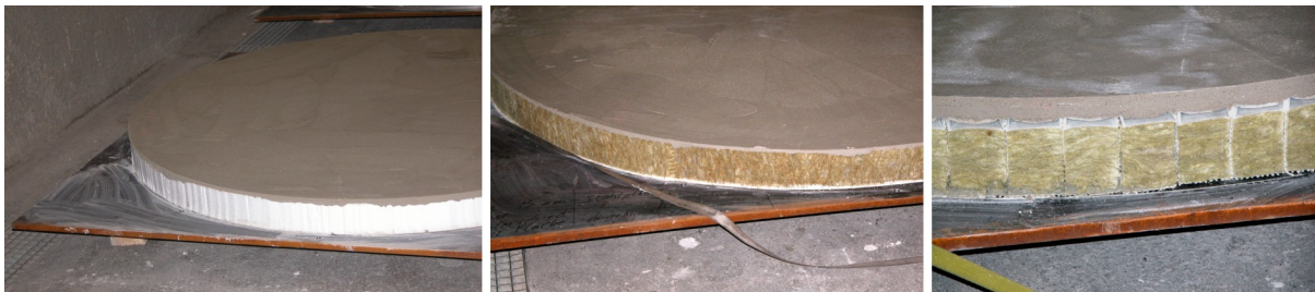
Abbildung 6.1: Fotos der Versuchskörper [139], links: Polystyrolschaum-WDVS, mittig: Mineralwolle-WDVS, rechts: PEKATEX®
