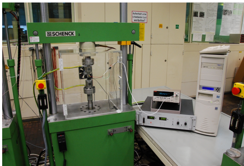
Abbildung 3.17: Servohydraulische Prüfanlage, Bild aus (Brucksch, 2009)
