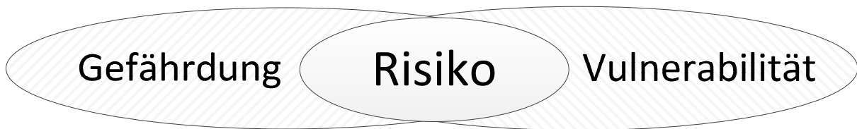
Abbildung 2-6: Risikodefinition im Hochwasserschutz 83
