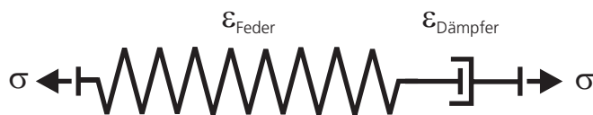
Bild 2–8: Lineares Maxwell Modell mit seriell geschalteter Feder und Dämpfer.
