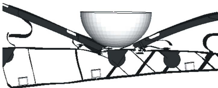
Bild 5–16: Vergleich des Verformungs- und Versagensverhalten mit dem verripptem Bauteil und einem kugelförmigen Impaktor bei einer Geschwindigkeit von 5.2 m/s auf eine Rippe und der Simulation mit dem neuen Materialmodell mit sofortigem Versagen der Elemente zu verschiedenen Zeitpunkten.
