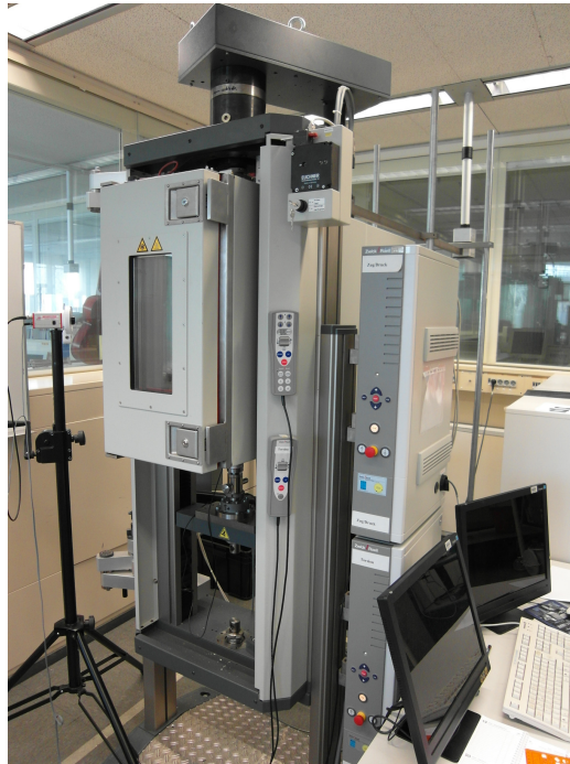
Abbildung 4.4 – Versuchseinrichtung zur Durchführung der uniaxialen quasi-statischen Experimente, Bild entnommen aus [18].
