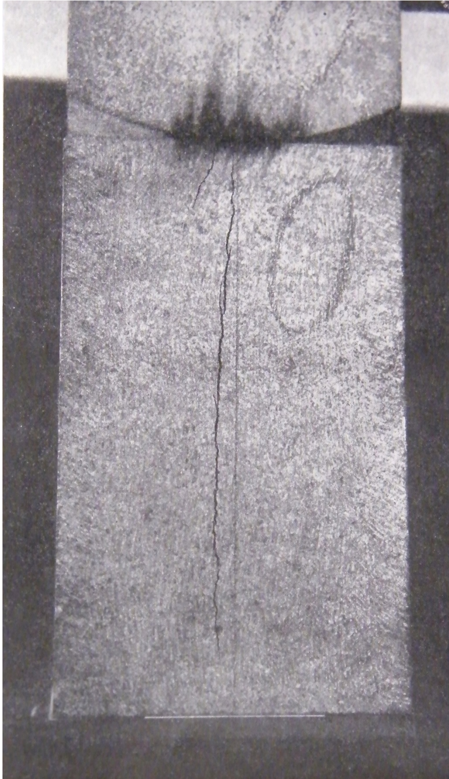
Abbildung 7.54: Form des Hauptrisses in Gelenkblöcken [Bach 1903c, S. 72]
