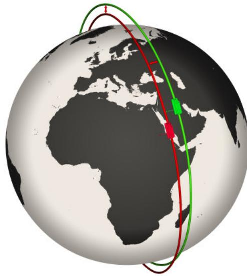
Abb. 41: Orbitkonstellation der Satelliten TerraSAR-X und TanDEM-X [57]
