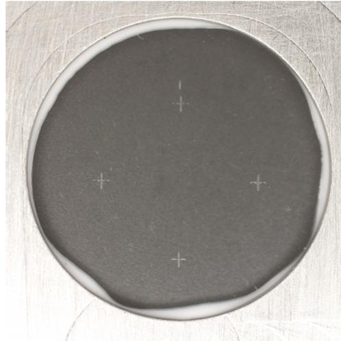
Abb. 3.24: Bild des mit Kreuzen markierten Szintillators. Die Zellen werden in dem Fensterbereich des LCI-Containers ausgesät und die bestrahlten Orte mit den Kreuzen rekonstruiert werden. Kreuzabstand ist 10 mm und Kreuzhöhe 1 mm.
