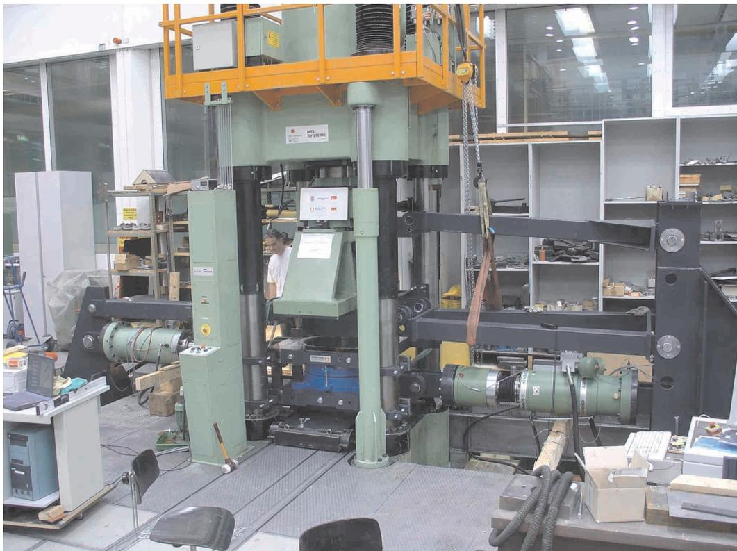
**Bild 5.7:** Versuchsaufbau für die Bilkent-Gleitpendellager
