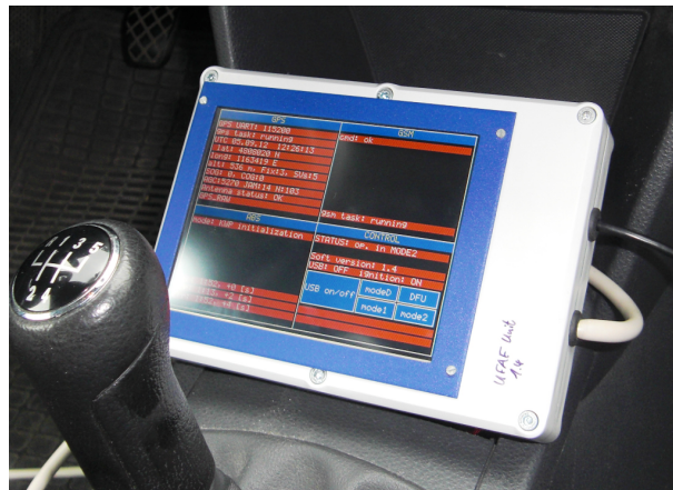
Abbildung 5.4: Im Projekt PUMA entwickeltes Schnittstellenmodul (OBU)
