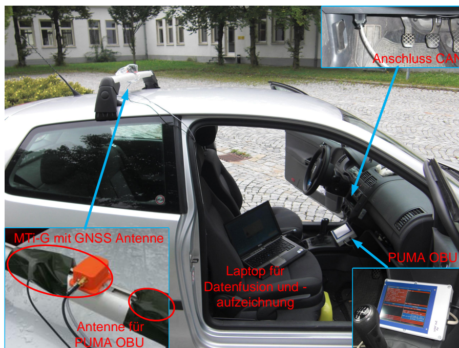
Abbildung 6.1: Vollständiger Hardwareaufbau des Systems auf Versuchsträger Volkswagen Polo 9N2
