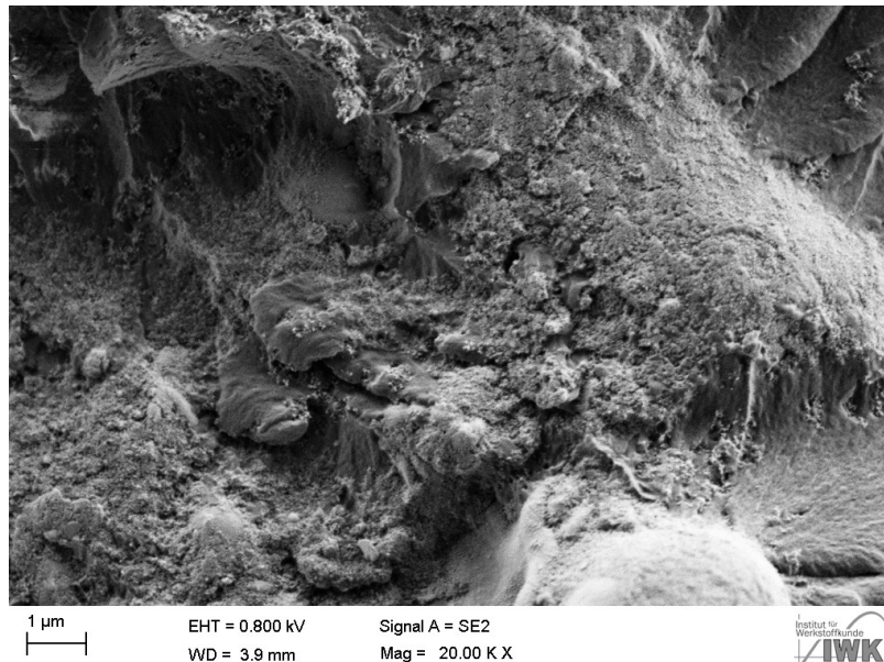
Abbildung 5-22 Ausschnitt aus Abbildung 5-21 (gelbes Rechteck): GF-nahes Versagen im Klebstoff
