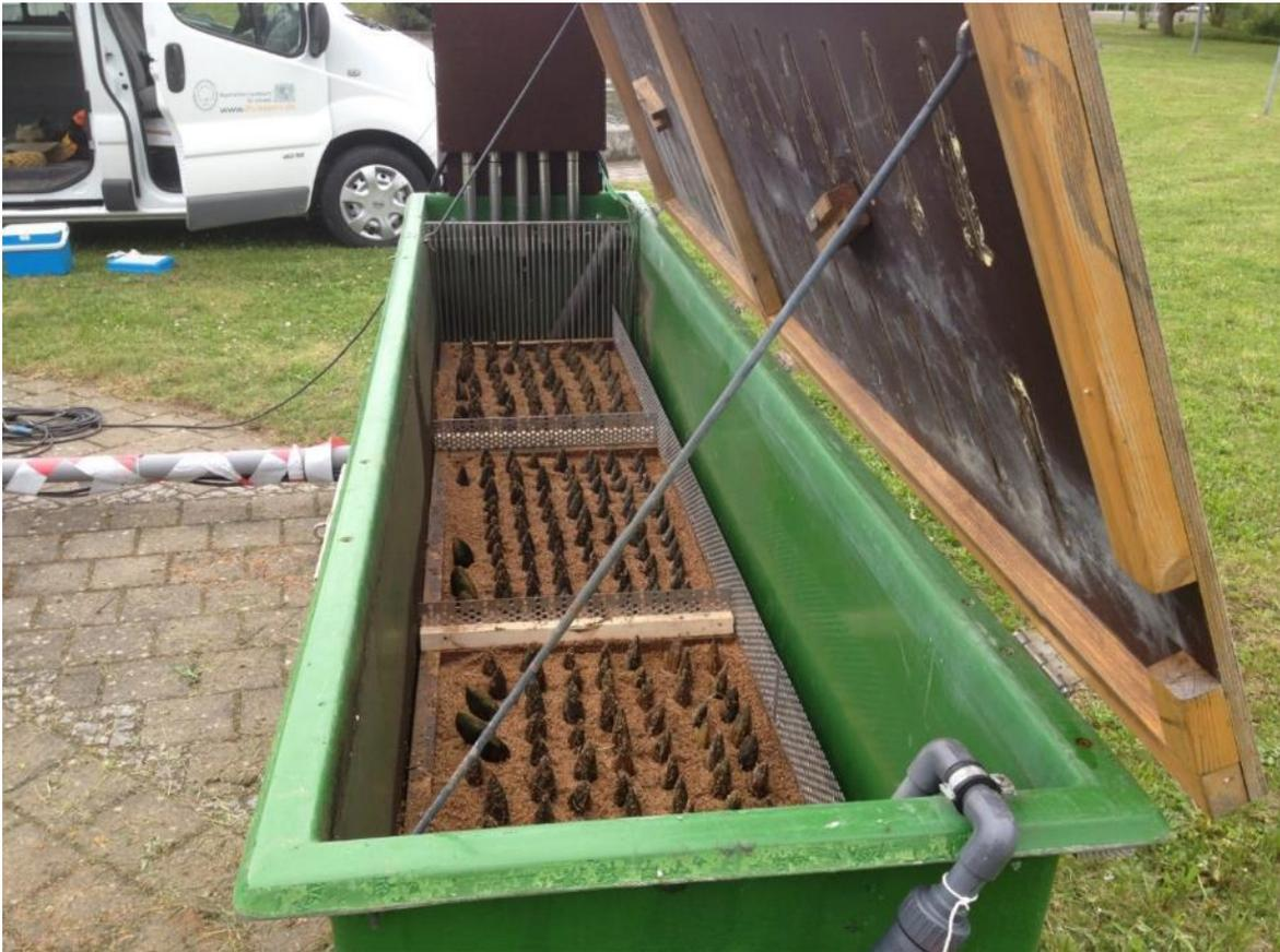
**Abbildung 90:** Langstromrinne zur Muschelexposition mit Online-Messsonden am Standort Kläranlagenablauf im Frühjahr 2015
