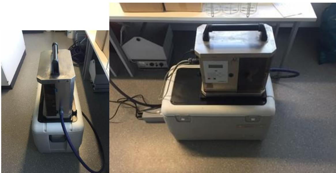
**Abbildung 64: Probenahmesystem auf der Kläranlage**
