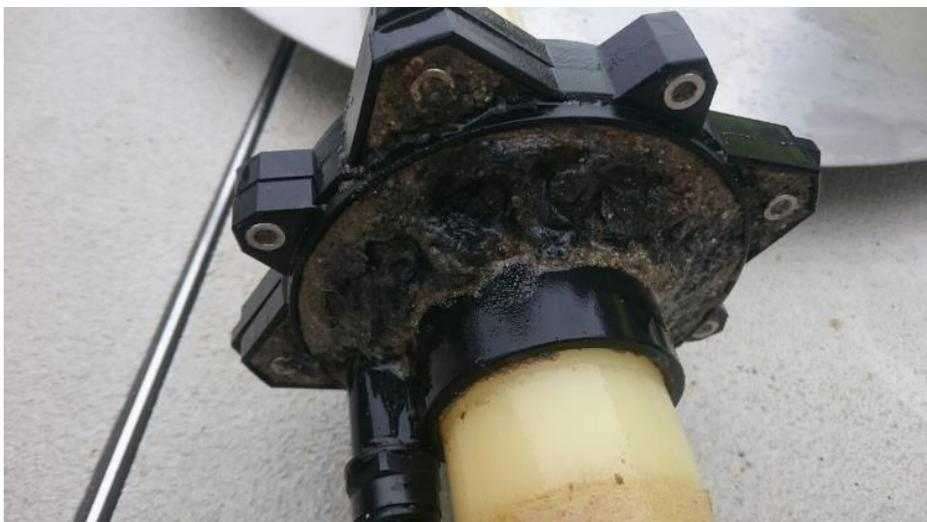
**Abbildung 133: Biofilmbewuchs Luftverteilerkopf der Mammutpumpe März 2018**
