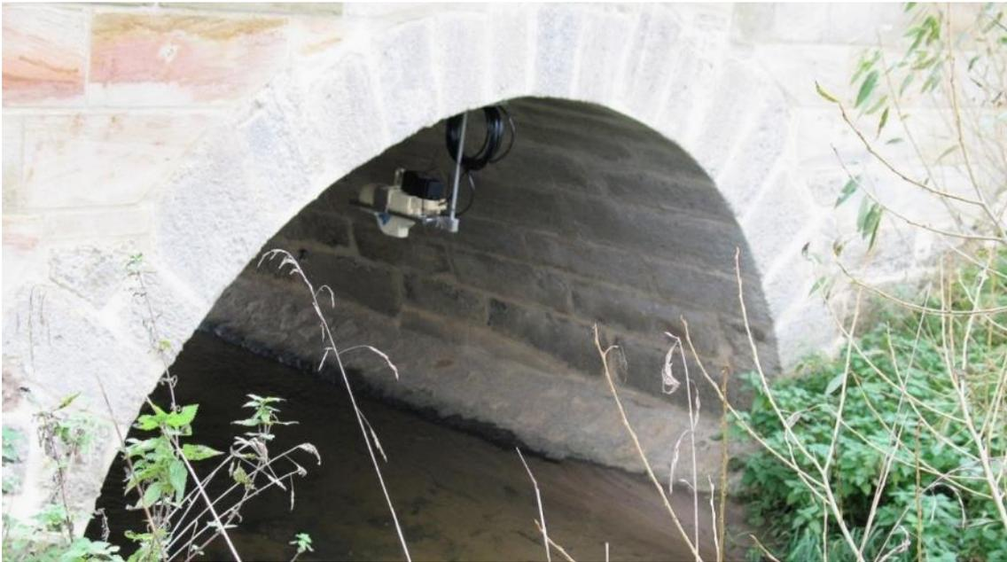
**Abbildung 87:** Abflussmessung an der Schwäbischen Rezat unterhalb der KA Weißenburg
