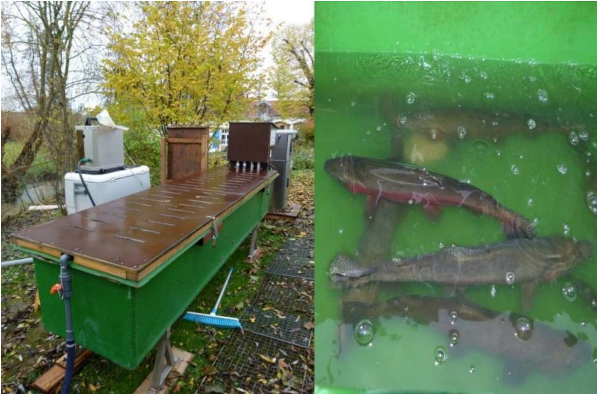
**Abbildung 86: Langstromrinne zur Fischexposition mit Probenehmer und Online-Messsonden am Stand-ort Silbermühle im Herbst 2014**
