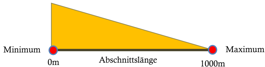
Abbildung 69: Grundmodell zur Modellierung der möglichen zusätzlich benötigten Innenschale
