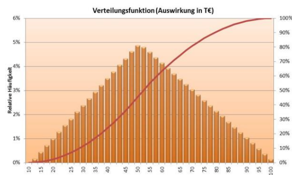
Abbildung 57: Vergleich der Ergebnisse zwischen LHS und MCS anhand einer Dreiecksverteilung
