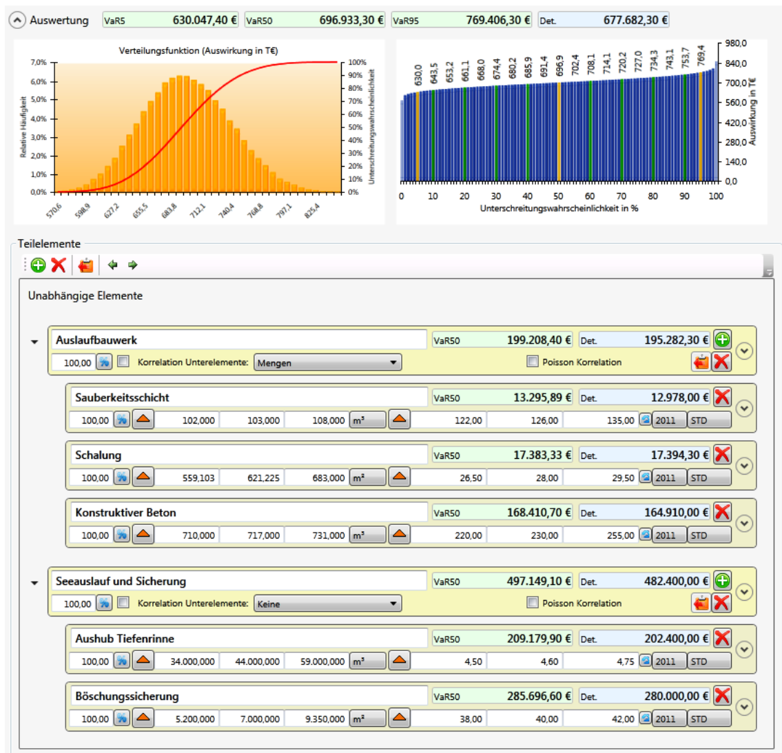
Abbildung 112: Teilelemente mit gruppierten und korrelierten Positionen (Gesamtergebnis oben)
