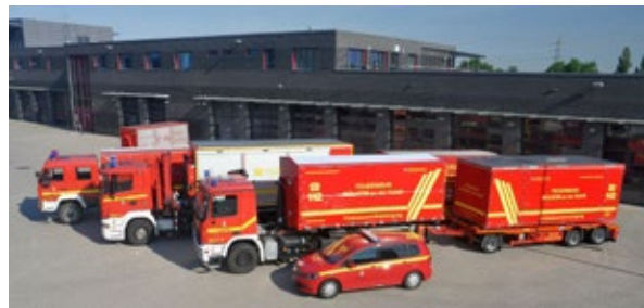
Abbildung 34: abmarschbereites Modulsystem „Trinkwassernotversorgung“ der Berufsfeuerwehr Mülheim an der Ruhr (Bildquelle: Lülff, 2019)
