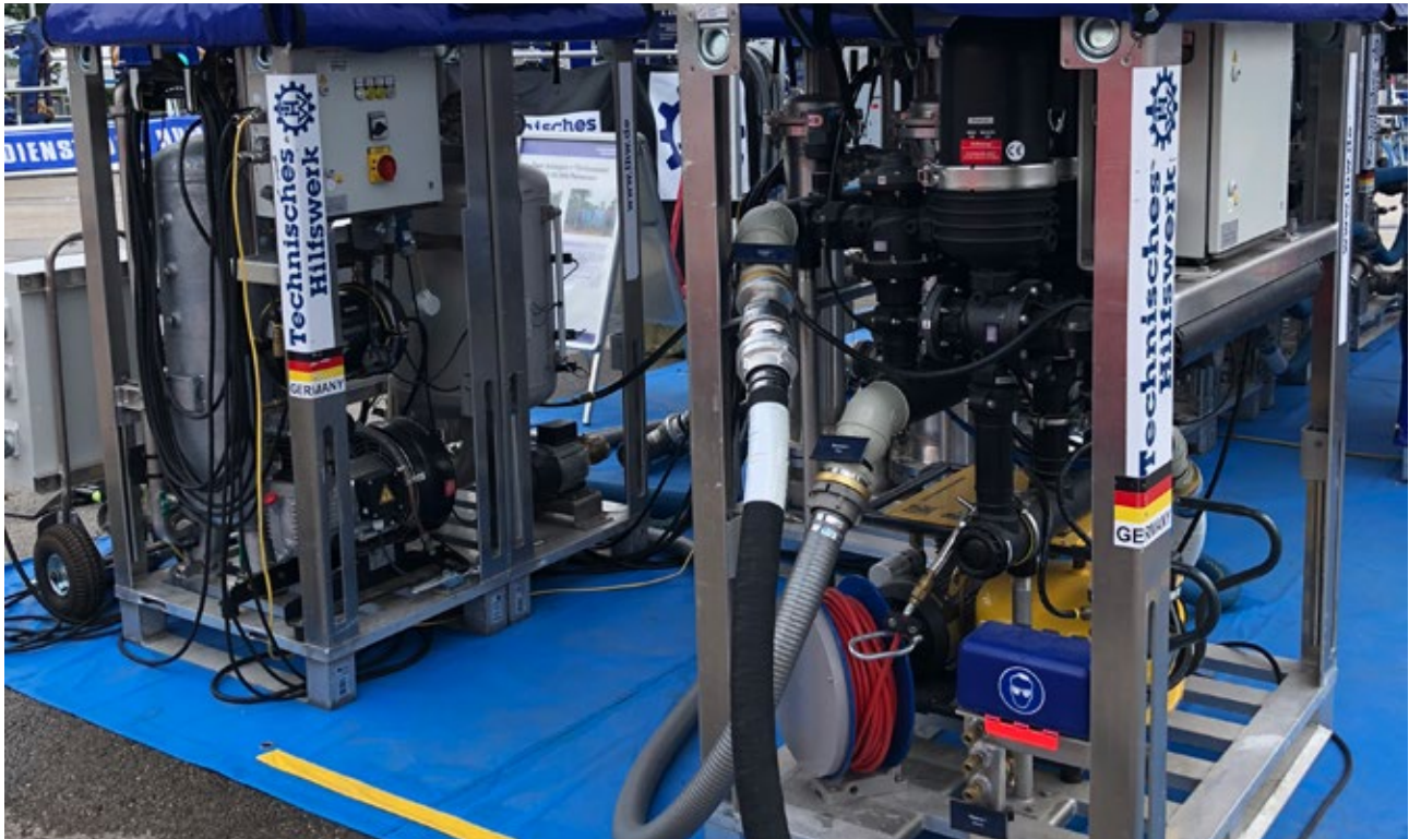
Abbildung 20: UF-15 Anlage des THW (Bildquelle: SWA)
