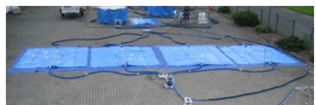
Abbildung 24: Leere, flexible Speicherbehälter (Bildquelle: DRK-Landesverband Hessen)
