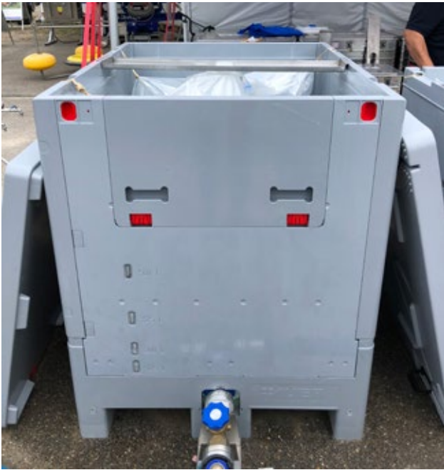
Abbildung 25: Speicherbehälter mit Einweg-Inlet (Bildquelle: SWA)
