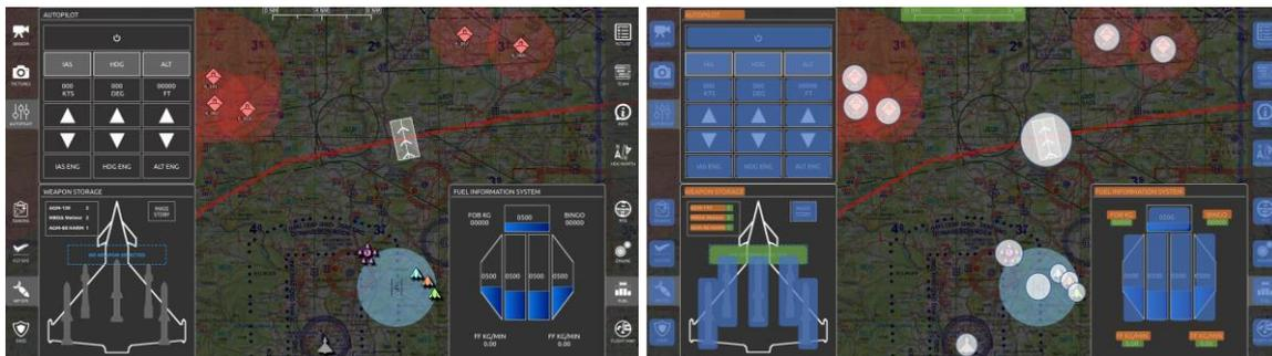
**Abbildung 28: Darstellung des zentralen Cockpitbildschirms links ohne und rechts mit Darstellung der semantischen Bedeutung**
