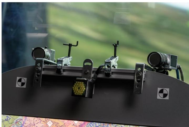
**Abbildung 25: Blickbewegungsmesssystem im Kampffjetsimulator**
