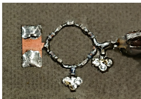
(a) Realisierte Monopol-Anpassungsschaltung
