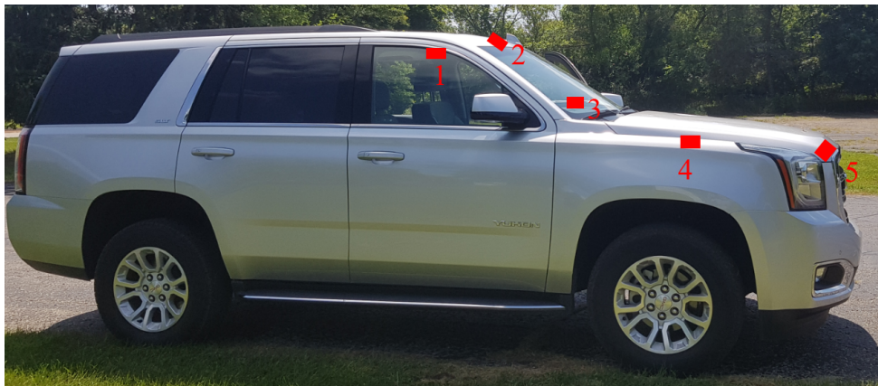
Abbildung 7.6: An einem von zwei Testfahrzeugen sind fünf untersuchte Antennenpositionen markiert, bei denen das Einzelantennen-Referenzsystem große Ausfallzeiten hervorgerufen hat.
