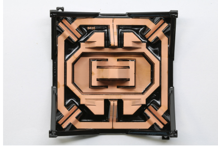
Abbildung 4.68: Unterseite des lackierten Trägerkörpers mit kupfernen Antennenstrukturen.
