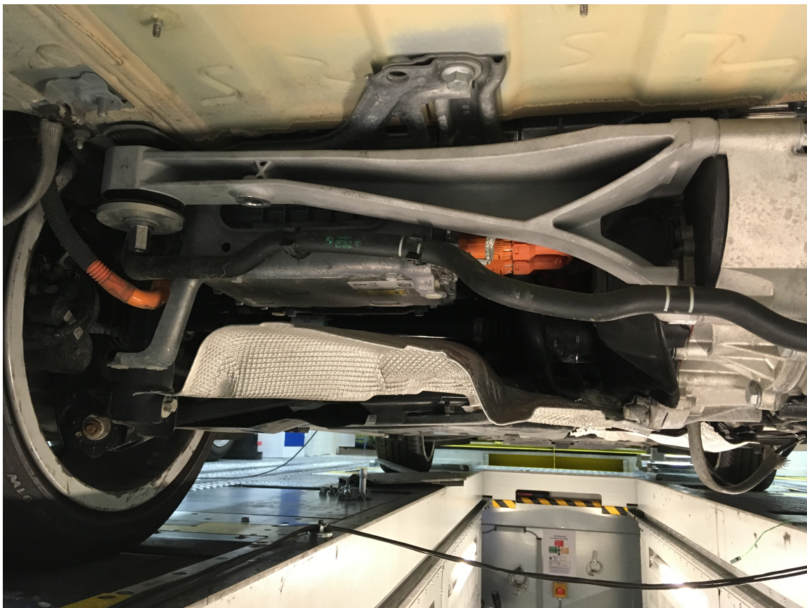
Abbildung 5.39: Getriebetragebock im Messfahrzeug auf dem Rollenprüfstand (Statortragebock aufgrund Verkapselung nicht sichtbar)
