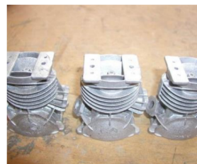
Abbildung 5.35: Ablauf des Fertigungsverfahrens der Motortragböcke im Feingussverfahren für Kleinserien und Prototypen [Vox15]
