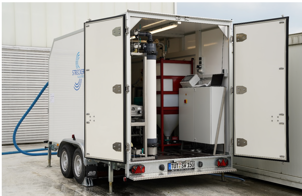
Abbildung 13: Demonstrator UF der Firma Strecker Wassertechnik aus dem Projekt NOWATER, Quelle: Universität der Bundeswehr München
