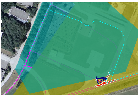
(c) Während MuCAR-3 im Konvoi-Betrieb durch Map-Critical-Bereiche fährt, wird der gefahrene Weg im Dead-Reckoning-System ohne Nutzung von GNSS-Daten aufgezeichnet (cyan, global noch nicht korrekt lokalisiert).
