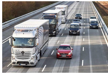
(a) Automatisiert fahrende LKW, über WLAN zum Platoon mit Straßenzulassung vernetzt. Quelle: Daimler
