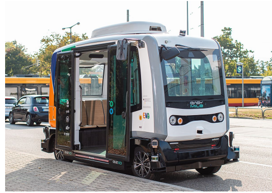
(b) EVA-Shuttle in Karlsruhe, ein Easymile EZ10 mit projektspezifischer Sensorik. Quelle: Paul Gärtner
