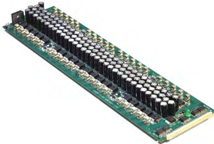
Abbildung 7.5: M 2 PC-Submodule mit zehn parallel geschalteten MOSFETs
