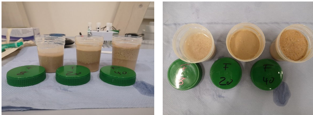
Abbildung 29: Gelagerte Proben bei einer Temperatur von 8, 20 und 40 °C nach 24 h aus zwei unterschiedlichen Perspektiven.
