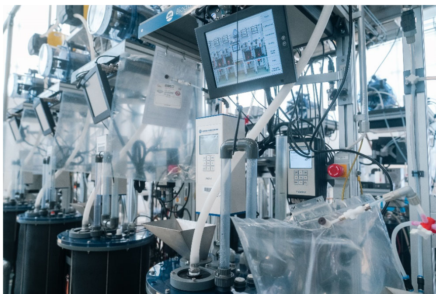
Abbildung 9: Foto der Versuchsfaulbehälter der Universität der Bundeswehr München (Foto: Siebold/UniBwM).
