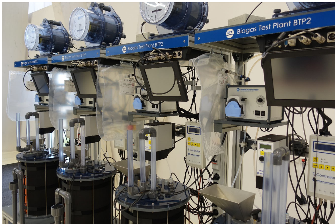
Abbildung 31: Versuchsaufbau der Laborfäulungen im Technikum der Professur für Siedlungswasserwirtschaft und Abfalltechnik der Universität der Bundeswehr München (Foto: Marcel Hagen)
