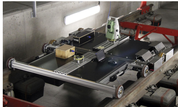
Abbildung 4: Gleismesswagen RACER II.
