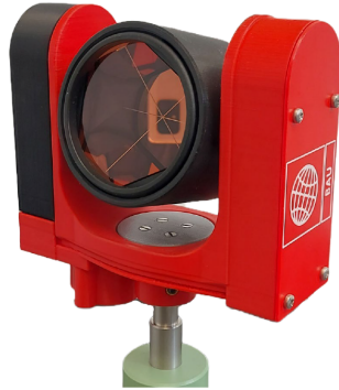
Abbildung 2: Motorisiertes Prisma (Pimpi, 2023).
