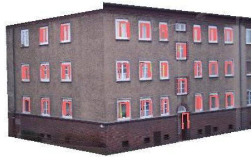
Abbildung 3: Automatisch mit Hilfe eines Verfahrens, das Computer Vision und Photogrammetrie kombiniert, interpretierte Gebäudefassade aus einer Arbeit von Prof. Mayer (Mayer & Reznik, 2006).
