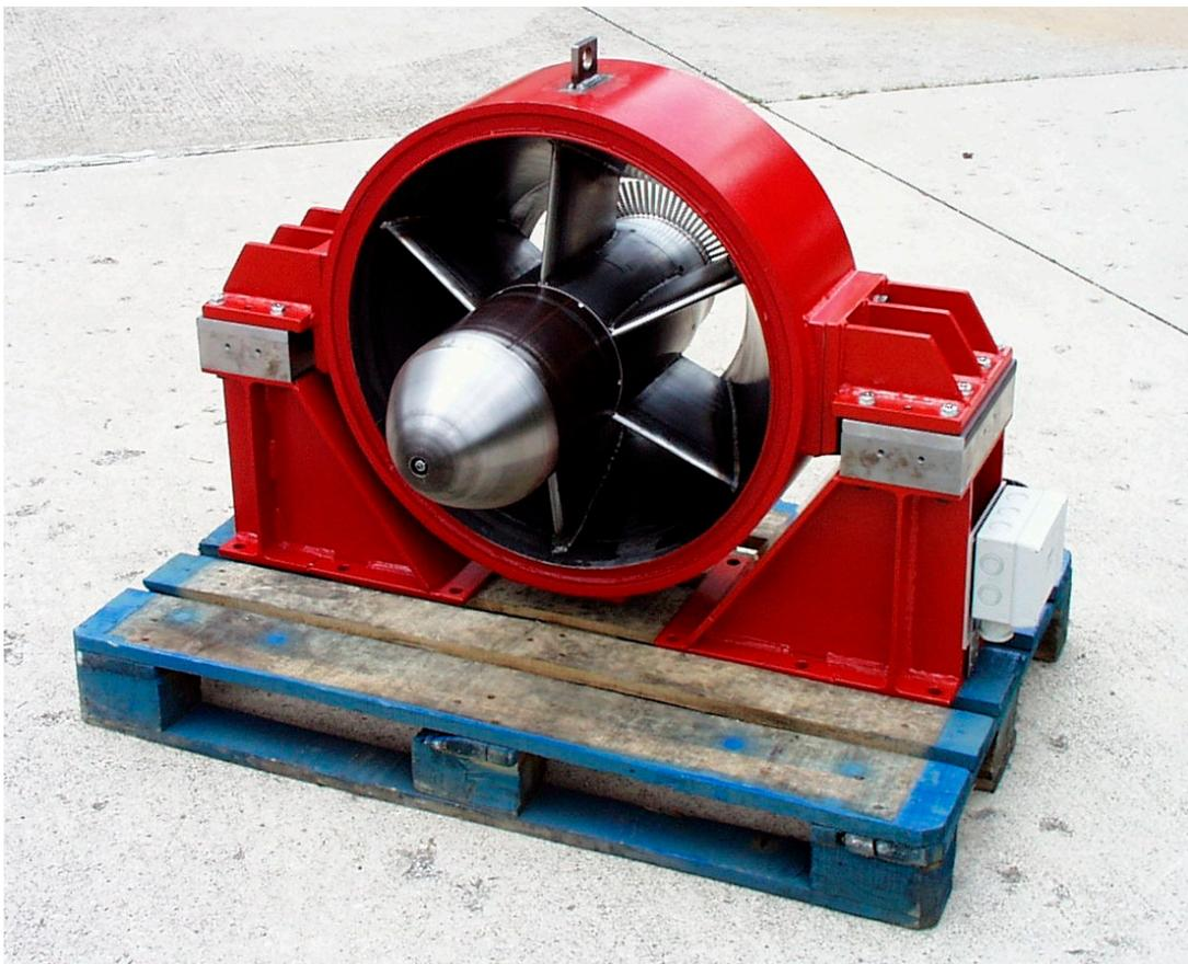
Abb. 3.8 Störgenerator vor dem Einbau am Verdichterprüfstand
