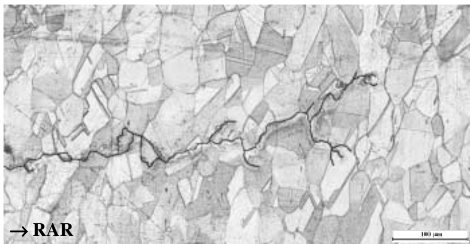
Abbildung 4.28: Nachgezeichneter Rissverlauf in polykristallinem Kupfer
