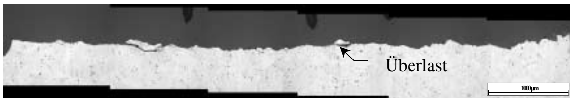
Abbildung 4.43: Rissverlauf in Bezug auf das Gefüge der Aluminiumlegierung 6013 T62
