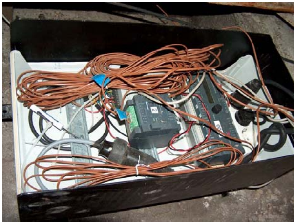
Abb. 6.55: Datenlogger zur Temperaturerfassung
