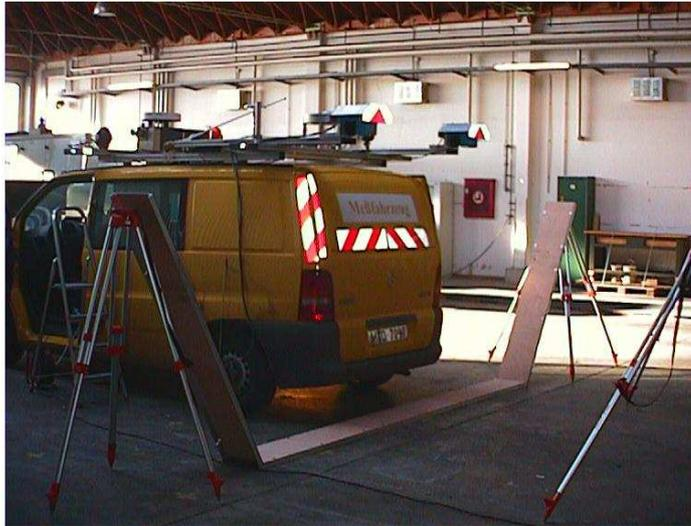
Abbildung 5.9.: Messaufbau zur geometrischen Kalibrierung der Laserscanner.
