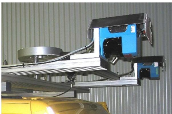
Abbildung 4.4.: Laserscanner-Messaufbau mit Ausrichtung beider Scanner nach unten.
