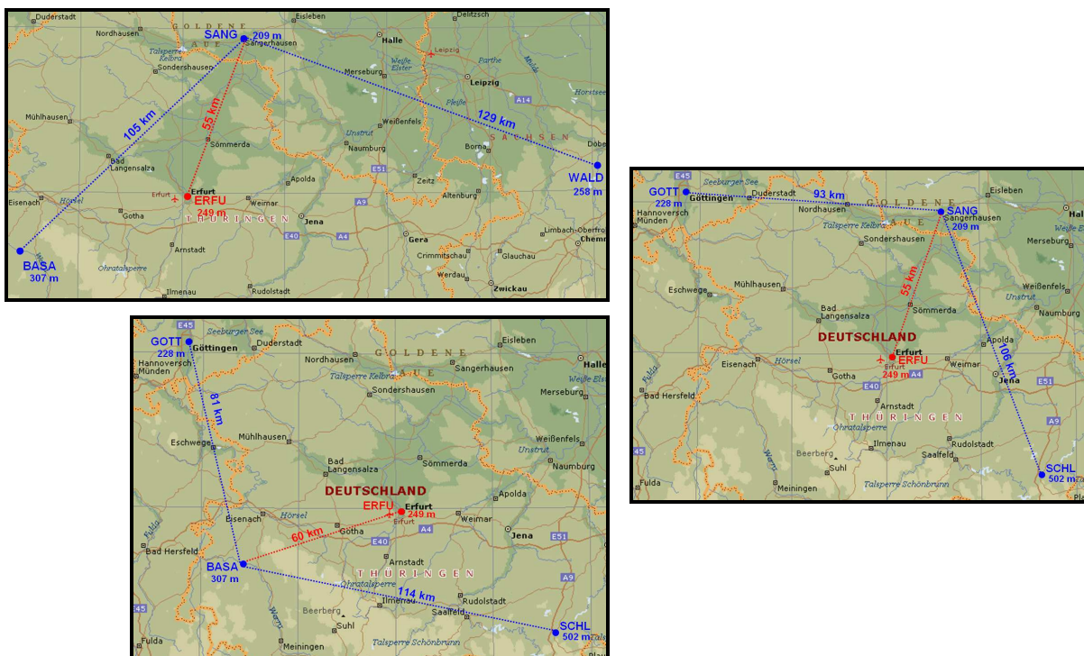
Abbildung 7-18: Netzkonfiguration beim Ausfall von einer Station und Hinzunahme einer entsprechend nächstgelegenen Station im großräumigen Netz
