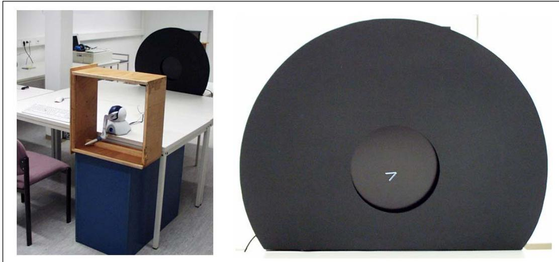
**Abb. 7-19** Experimentalsystem für die Wahrnehmung von Objektkanten. Der Proband nimmt auf dem Stuhl links im Bild Platz und greift für die unimodal haptische sowie bimodale Darbietung den Taststift des PHANTOM® Device. Die visuellen Reize werden auf einem 1.5 m entfernt positionierten TFT-Monitor dargeboten.
