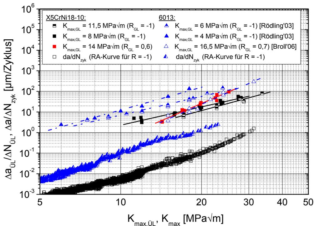
Abbildung 4.2-15:  $\Delta a_{\dot{U}L}$  und  $\frac{da}{dN_{zyk}}$  über  $K_{\max, \dot{U}L}$  bzw.  $K_{\max}$  – Vergleich von X5CrNi18-10 und 6013
