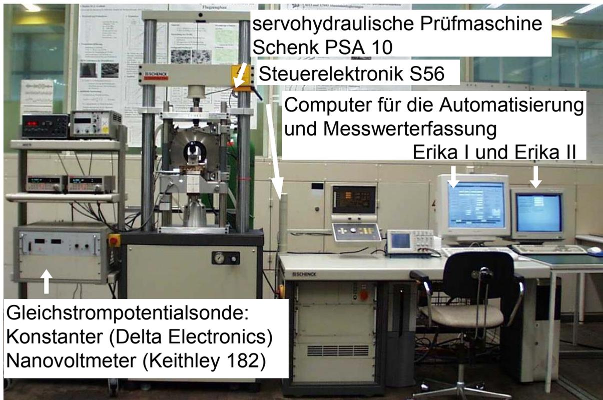
**Abbildung 3.2-2: Versuchsanlage ERIKA für die Rissfortschrittsexperimente**
