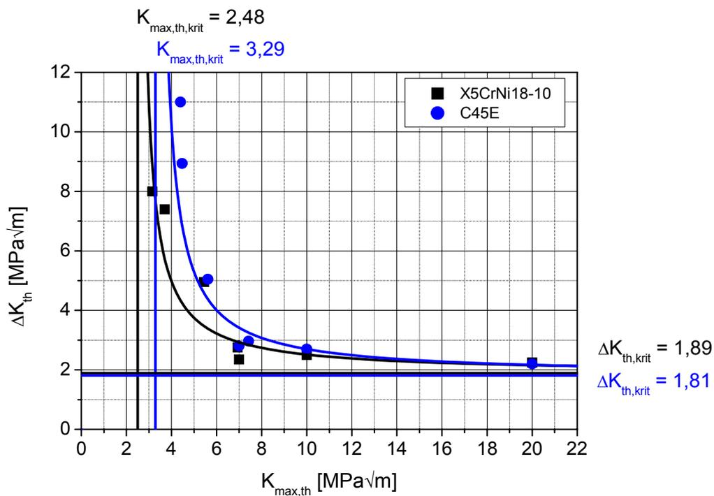
**Abbildung 5.2-6: Schwellenwerte  $\Delta K_{th}$  über  $K_{\max,th}$**
