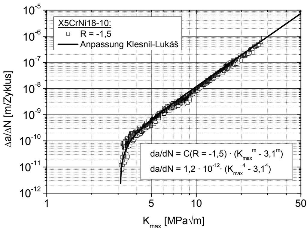
**Abbildung 5.3-2: Anpassung der Rissausbreitungskurve mit  $R = -1,5$**
