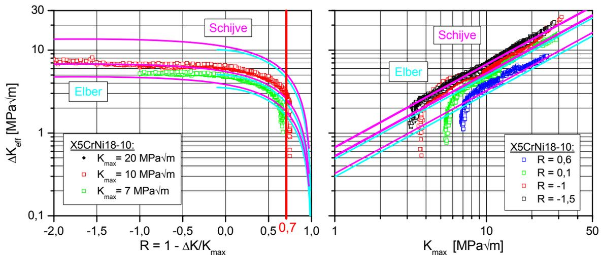
**Abbildung 5.2-9:  $\Delta K_{\text{eff}}$  nach Elber, Schijve und aus den Experimenten berechnet über  $R$  und  $K_{\text{max}}$**
