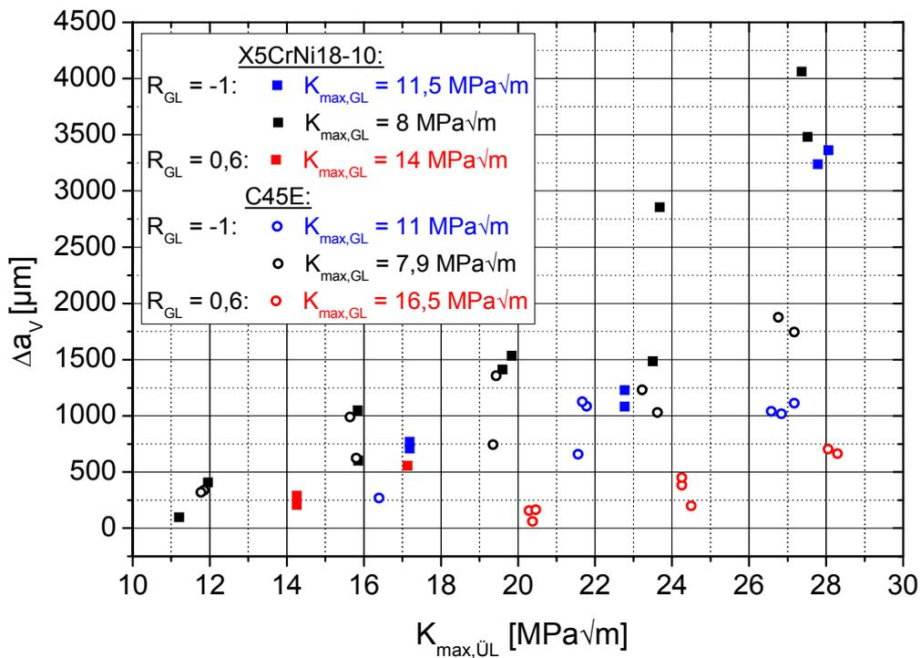
Abbildung 4.2-8: Einfluss von Überlasthöhe,  $K_{max,GL}$  und  $R_{GL}$ -Wert auf  $\Delta a_v$  im X5CrNi18-10 und C45E
