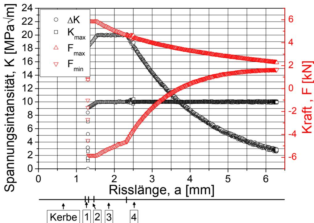
**Abbildung 3.2-6: Versuchsregelung der alternativen Schwellenwertermittlung**
