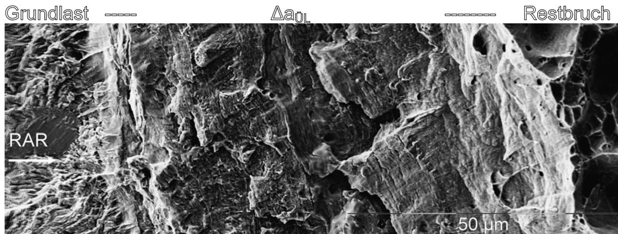
**Abbildung 4.2-17: Bruchflächenstruktur von  $\Delta a_{\text{ÜL}}$  im X5CrNi18-10**
