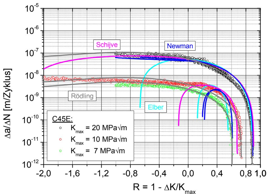
**Abbildung 4.1-11: Beschreibung der Experimente der alternativen Schwellenwertermittlung am C45E über die Funktion  $\left. \frac{da}{dN} \right|_{alt} (R)$**
