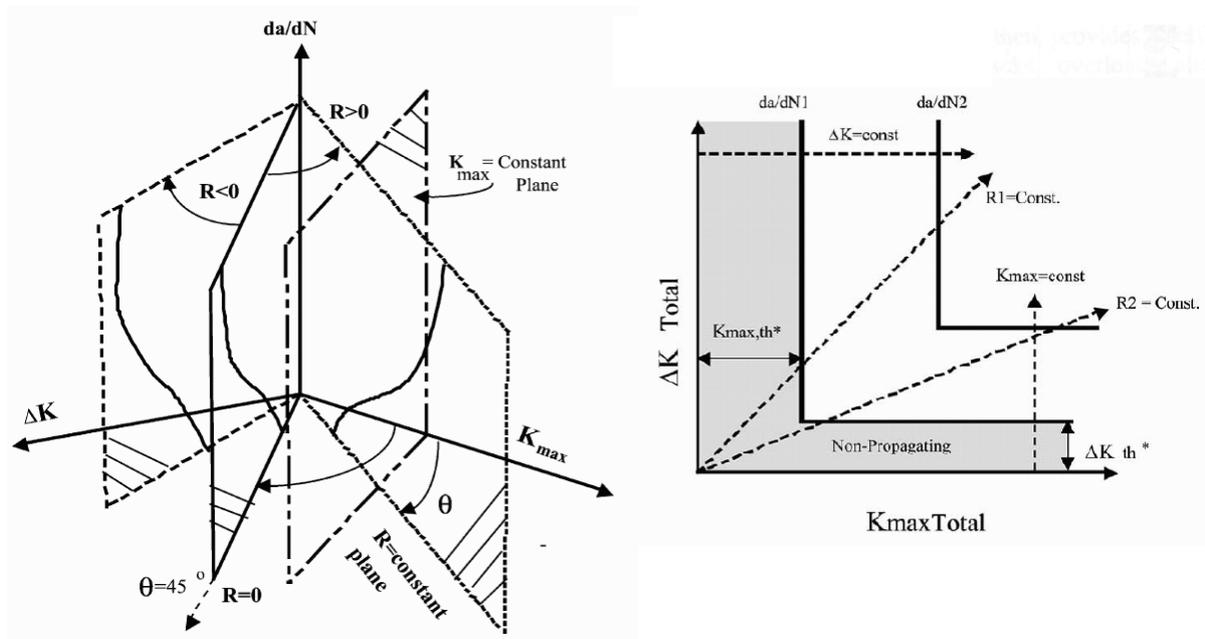
**Abbildung 5.2-2: Ermüdungsrissausbreitung in Abhängigkeit von  $K_{\max}$  und  $\Delta K$  nach Sadananda [Sadananda'04]**
