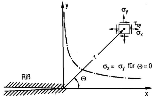
**Abbildung 2.1-2: Koordinatensystem vor der Rissspitze und Verlauf der Spannungskomponenten  $\sigma_x$  und  $\sigma_y$  auf dem Ligament (nach [Haibach'89])**
