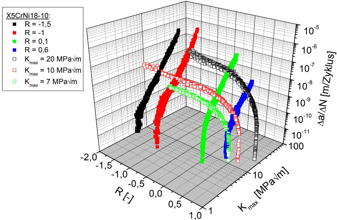
**Abbildung 5.2-1: 3D-Darstellung der Rissausbreitungsexperimente am X5CrNi18-10**
