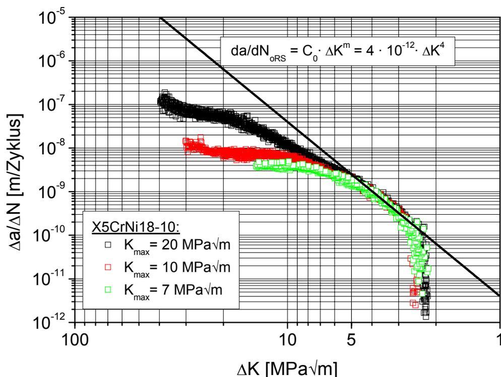
Abbildung 5.2-7: Ermittlung des Parameters  $C_0$  über die experimentellen Daten der alternativen Schwellenwertermittlung am X5CrNi18-10
