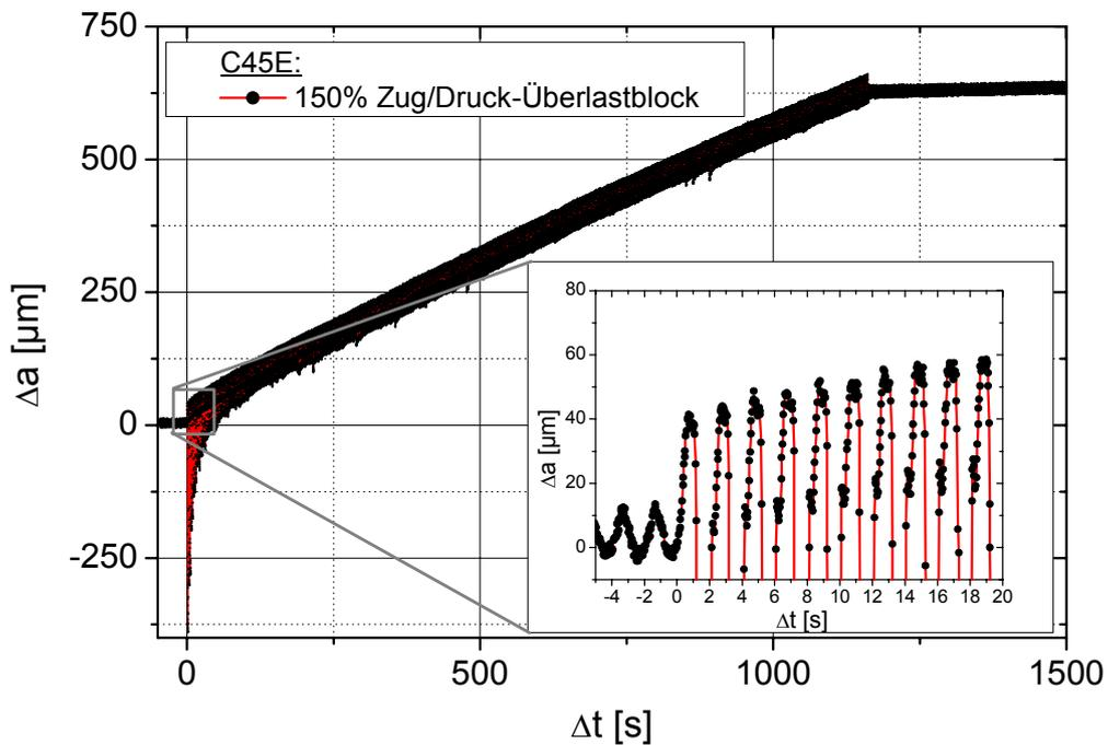
Abbildung 4.2-9: Rissverlängerung im Überlastblock (Messdaten Rechner Erika II)
