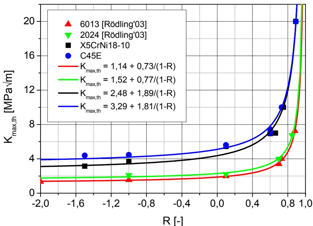
**Abbildung 5.2-5: Ermittlung der Parameter der Funktion  $K_{\max,th}(R)$**
