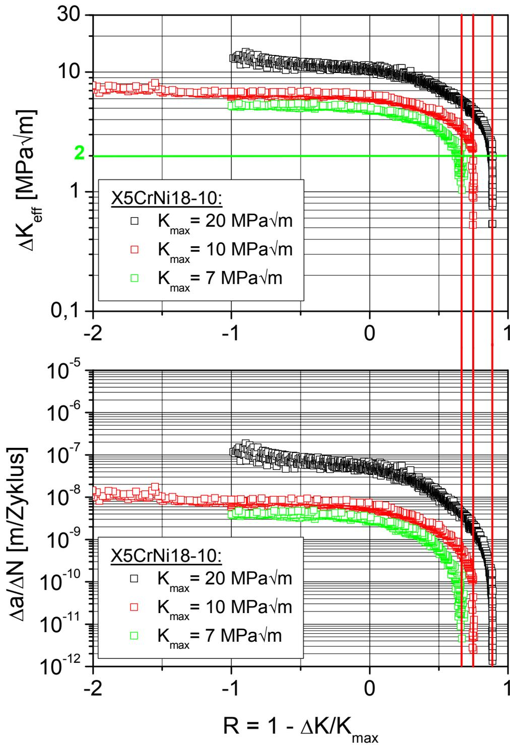
Abbildung 5.2-11: Rissausbreitungskurven ( $K_{\max}$ =konstant) und  $\Delta K_{\text{eff}}$  (berechnet) des X5CrNi18-10
