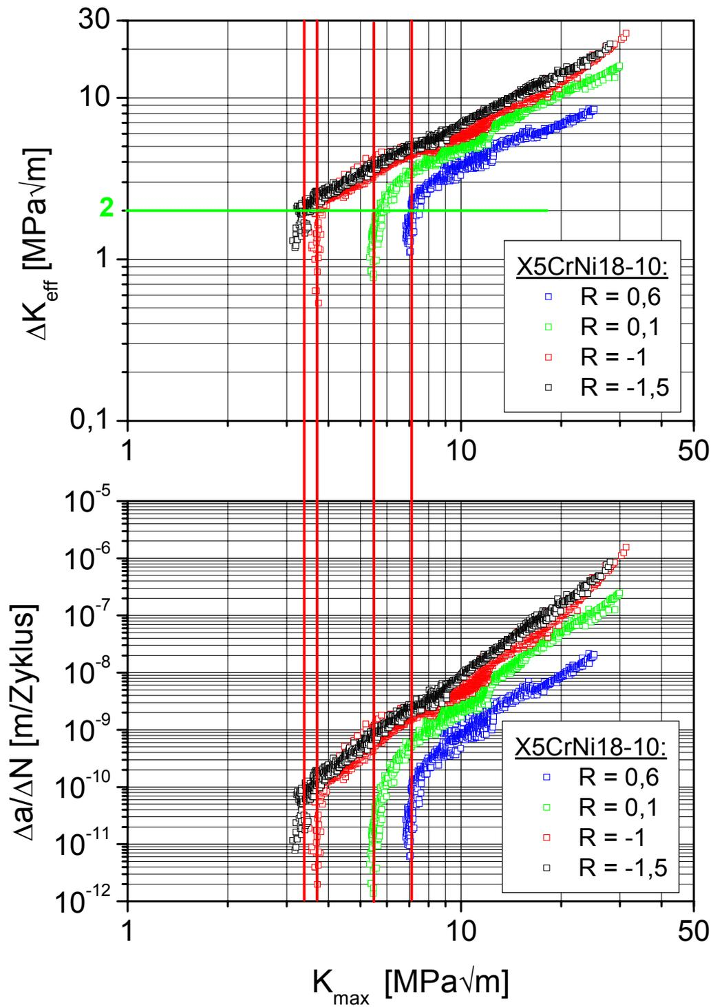
Abbildung 5.2-10: Rissausbreitungskurven ( $R=\text{konstant}$ ) und  $\Delta K_{\text{eff}}$  (berechnet) des X5CrNi18-10
