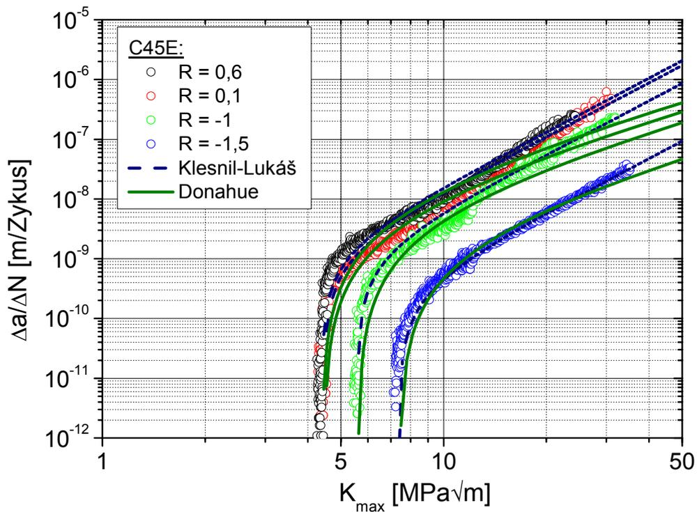
Abbildung 4.1-8: Anpassung von Rissfortschrittsgesetzen an die Rissausbreitungskurven von C45E
