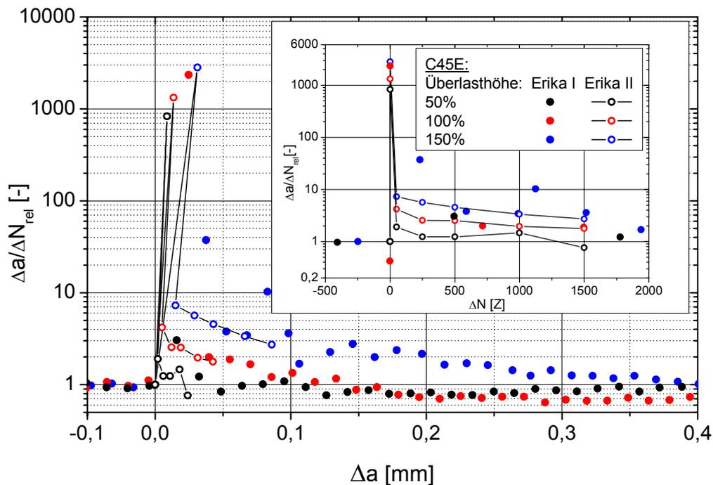
**Abbildung 4.2-3: Vergleich der Rissfortschrittsrate (Messdaten des Rechners Erika I mit den Messdaten des Rechners Erika II) infolge einer Zugüberlast im C45E**
