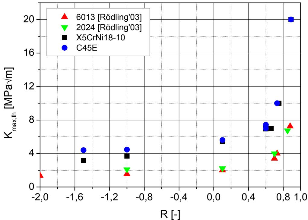
**Abbildung 5.2-4: Schwellenwerte  $K_{\max,th}$  in Abhängigkeit vom R-Wert**
