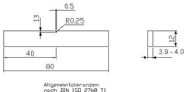
Abbildung 3.2-1: Einseitig gekerbte Flachprobe für die Rissfortschrittsexperimente mit der Versuchsanlage ERIKA
