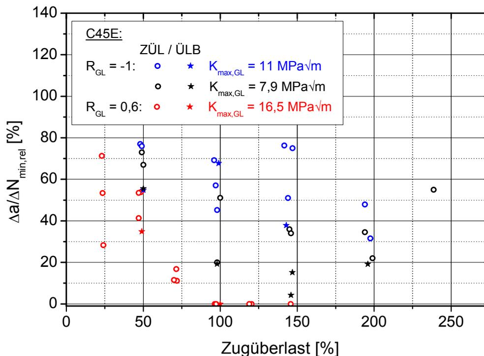
Abbildung 4.2-13: Vergleich von  $\Delta a/\Delta N_{min,rel}$  bei einfachen ZÜL und ÜLB im C45E
