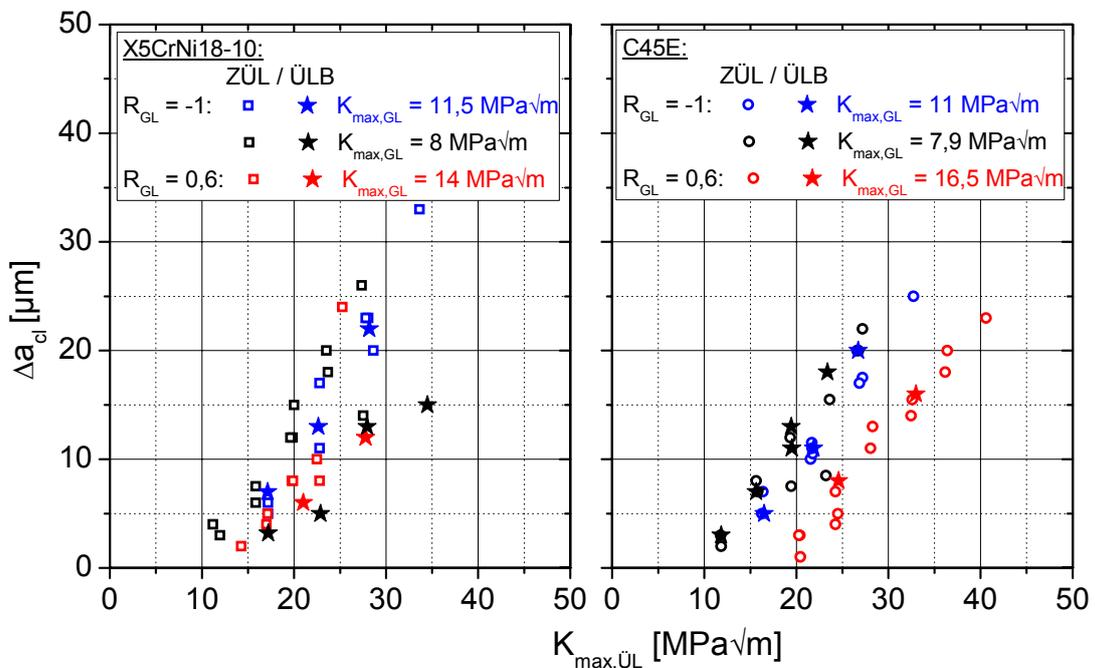
Abbildung 4.2-10: Vergleich von  $\Delta a_{cl}$  bei einfachen ZÜL und ÜLB beim X5CrNi18-10 und C45E
