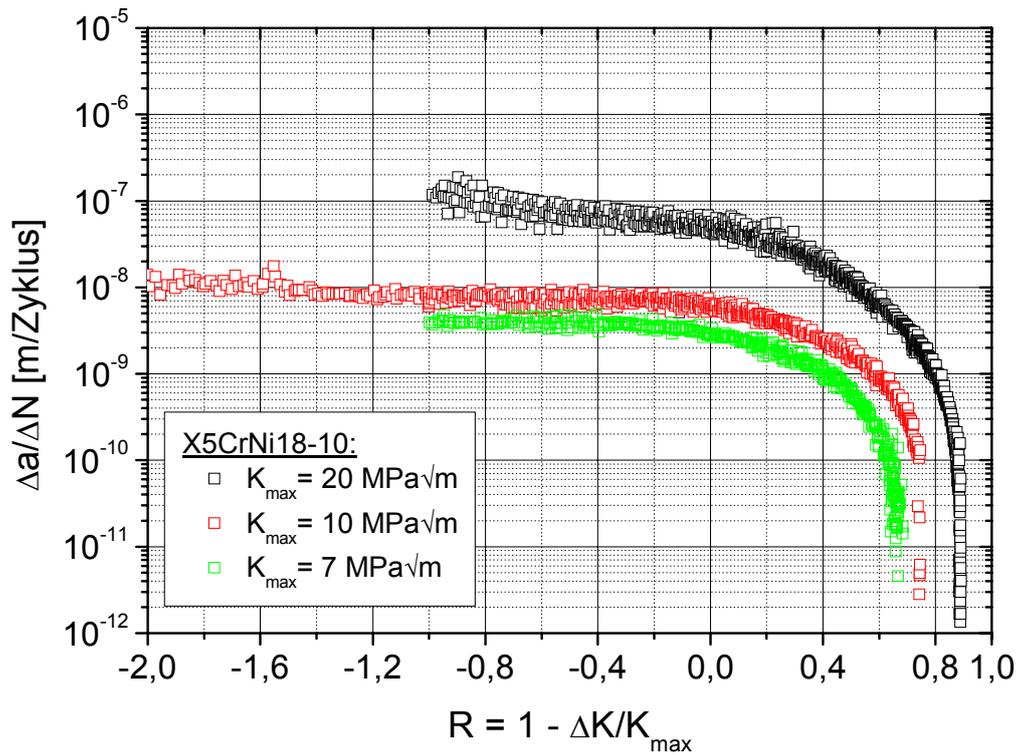
Abbildung 4.1-3: Rissausbreitungskurven der alternativen Schwellenwertermittlung von X5CrNi18-10 ( $\Delta a/\Delta N$  über R)
