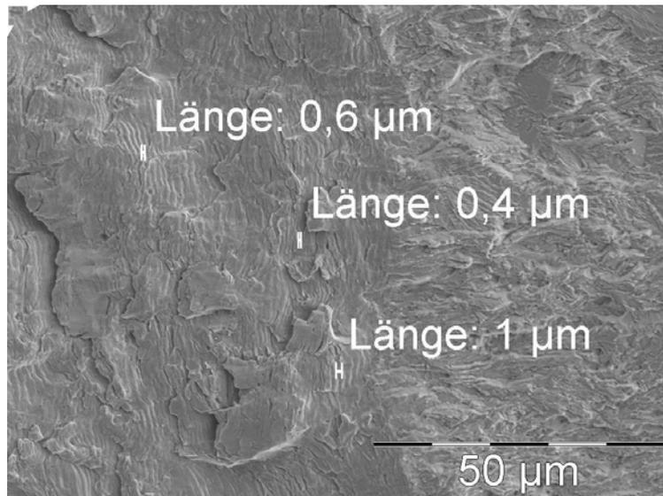
Abbildung 4.2-20: Übergang Überlastblock 150% - Grundlast
