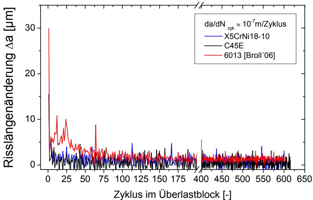
**Abbildung 4.2-23: Entwicklung der Risslängenänderung im Überlastblock in Stahl und Aluminium**
