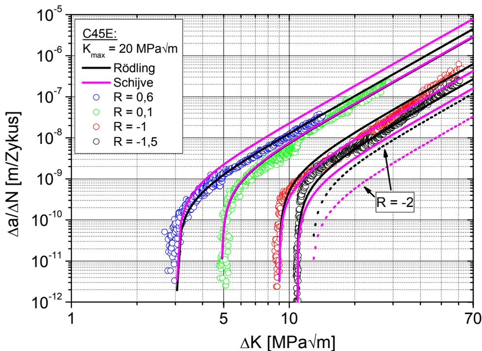
**Abbildung 4.1-13: Berechnete Rissausbreitungskurven über die Funktion von Rödling und nach dem Risssschließen von Schijve**
