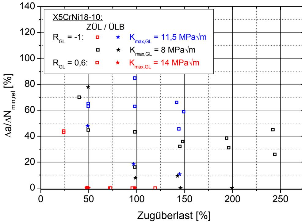
Abbildung 4.2-12: Vergleich von  $\Delta a/\Delta N_{min,rel}$  bei einfachen ZÜL und ÜLB im X5CrNi18-10
