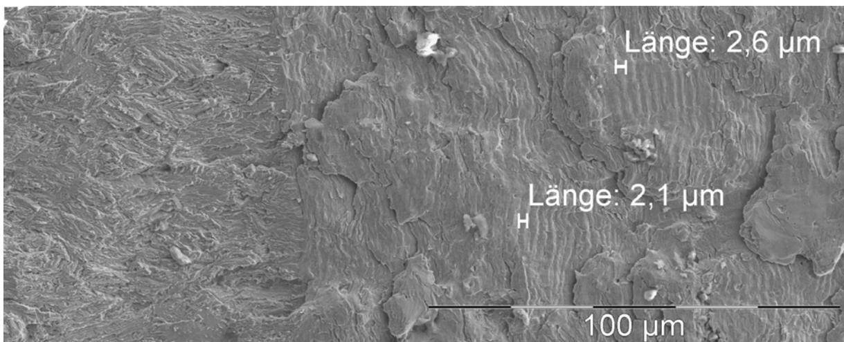
**Abbildung 4.2-19: Übergang Grundlast – Überlastblock 150%**
