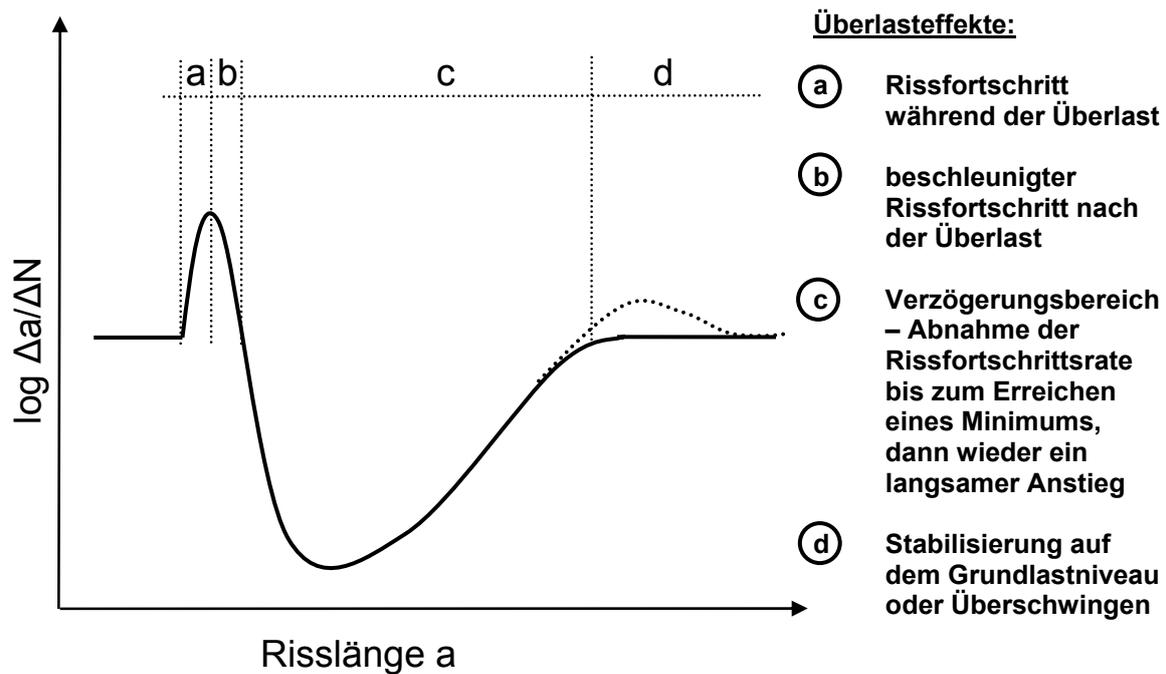
**Abbildung 2.2-11: Schema - Effekte einer Zugüberlast auf den Rissfortschritt**
