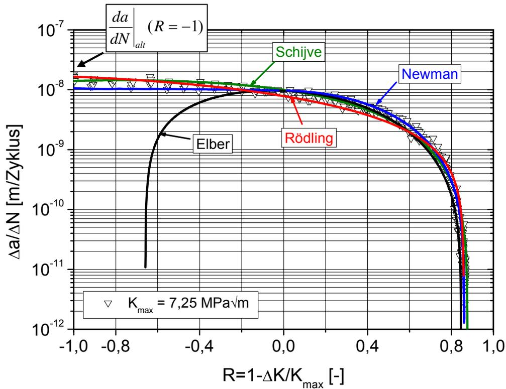
**Abbildung 2.2-8: Parameterermittlung der C(R) Funktion anhand der Rissausbreitungskurve der alternativen Schwellenwertmessung [Rödling'03]**
