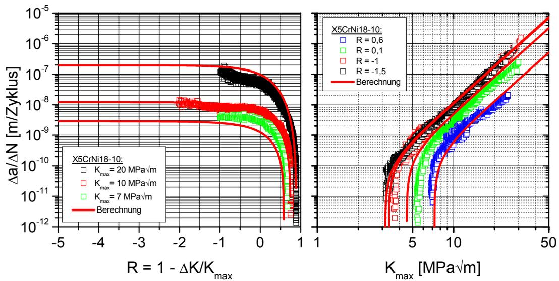
**Abbildung 5.3-7: Berechnete Rissfortschrittsrate im Vergleich mit den Rissausbreitungskurven**
