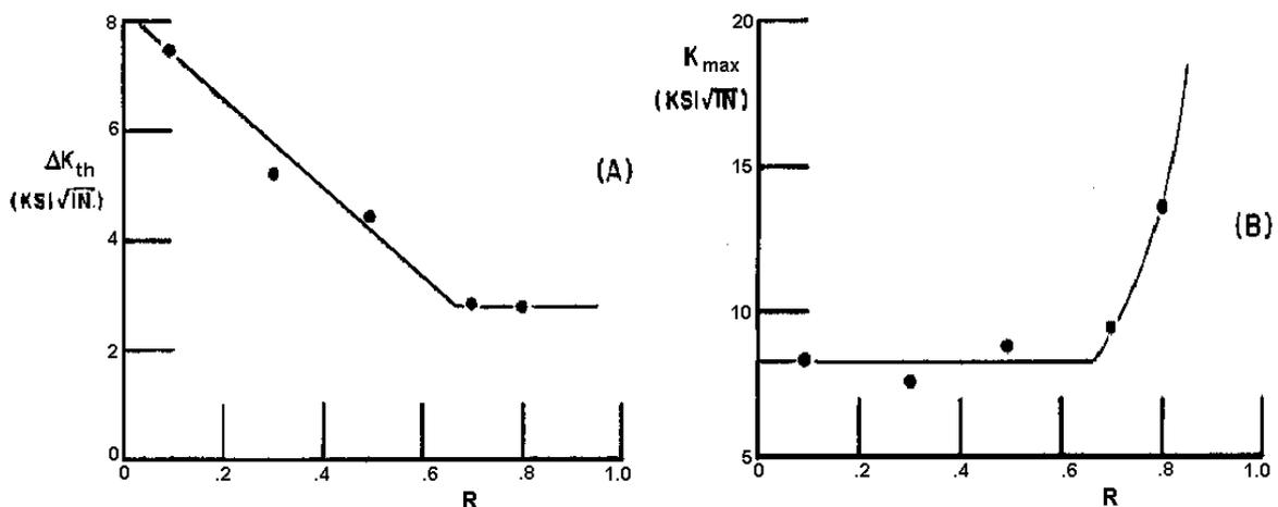
Abbildung 2.2-5: Schwellenwerte  $\Delta K_{th}$  und  $K_{max,th}$  in Abhängigkeit vom Spannungsverhältnis R des Stahls A533 [Schmidt'73]
