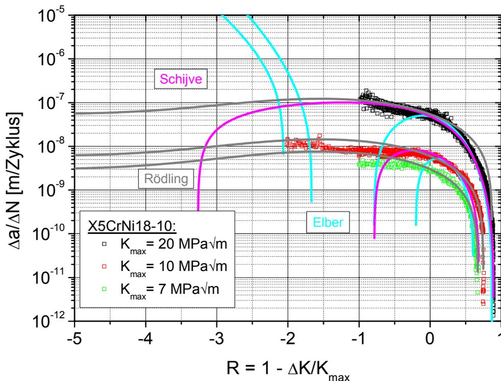
**Abbildung 5.1-1:** Anpassungen der Experimente der alternativen Schwellenwertermittlung dargestellt für R-Werte bis  $-5$
