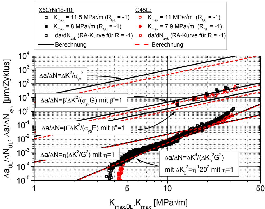
**Abbildung 5.4-1: Vergleich der berechneten Rissfortschrittsrate mit  $\Delta a_{\text{ÜL}}$  und mit der zyklischen Rissfortschrittsrate**
