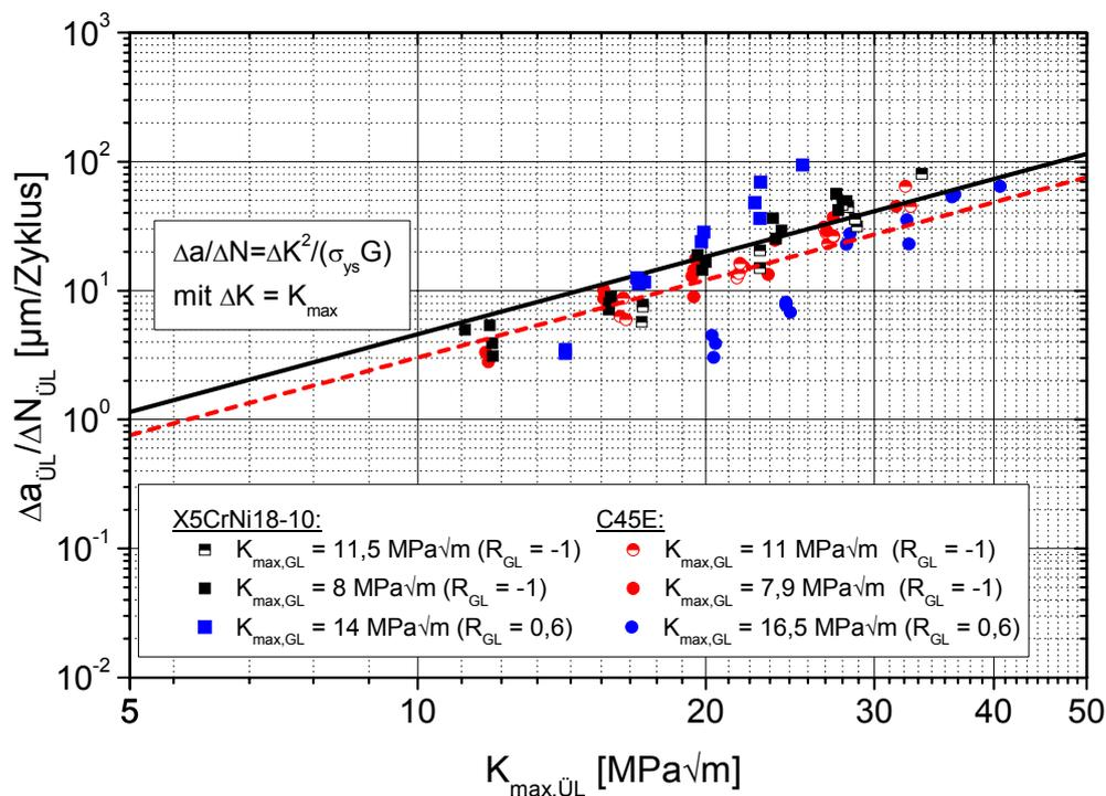
**Abbildung 5.4-2: Vergleich der berechneten Rissfortschrittsrate mit  $\Delta a_{\text{ÜL}}$**
