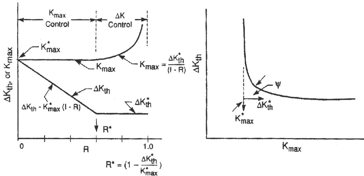
**Abbildung 2.2-6: Abhängigkeit des Schwellenwertes von R und die „fundamental threshold curve“ [Sadananda'95]**
