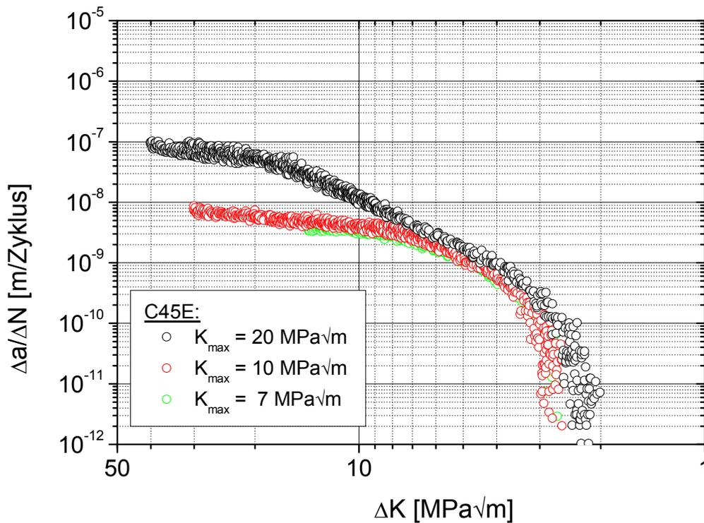
Abbildung 4.1-6: Rissausbreitungskurven der alternativen Schwellenwertermittlung von C45E ( $\Delta a/\Delta N$  über  $\Delta K$ )
