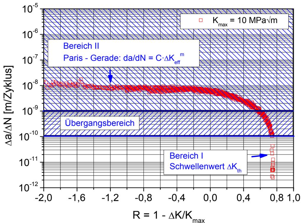
**Abbildung 5.1-2: Übertragung der Bereiche I und II der Ermüdungsrissausbreitung auf die Darstellung der Rissausbreitungskurve der alternativen Schwellenwertermittlung**
