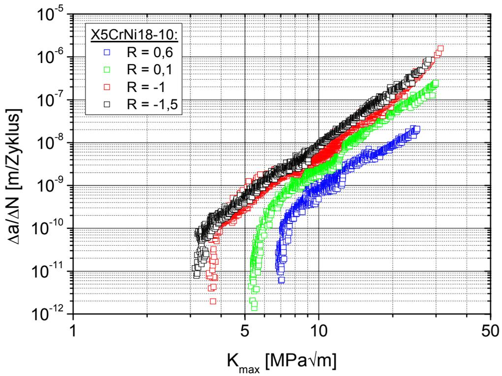
Abbildung 4.1-1: Rissausbreitungskurven von X5CrNi18-10
