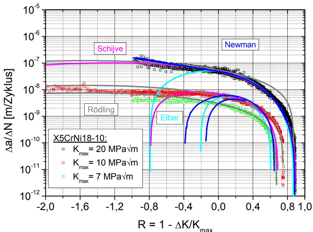
Abbildung 4.1-10: Beschreibung der Experimente der alternativen Schwellenwertermittlung am X5CrNi18-10 über die Funktion  $\left. \frac{da}{dN} \right|_{alt}(R)$
