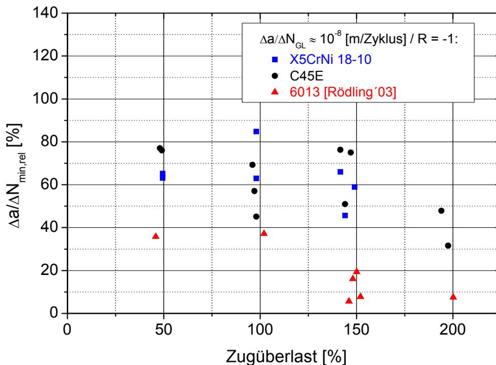
**Abbildung 4.2-22: Vergleich Stahl und Aluminium  $\Delta a / \Delta N_{\min,rel}$  über der Zugüberlasthöhe**
