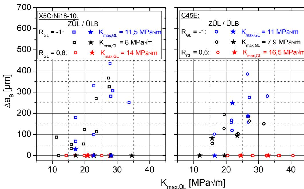
**Abbildung 4.2-11: Vergleich von  $\Delta a_B$  bei einfachen ZÜL und ÜLB beim X5CrNi18-10 und C45E**
