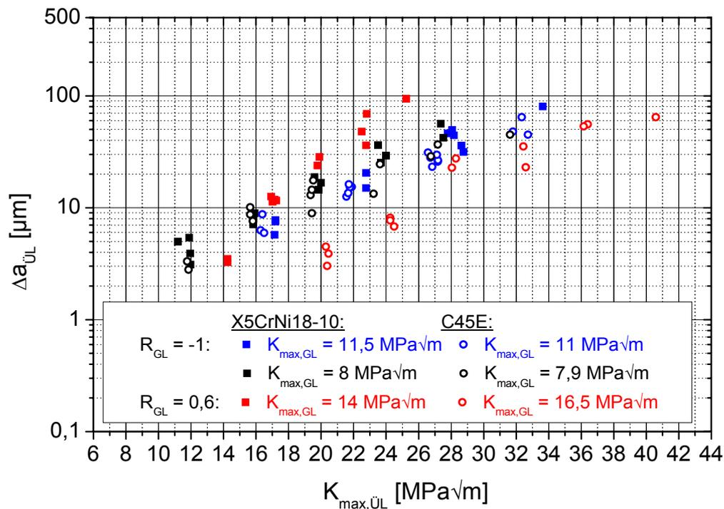
**Abbildung 4.2-4: Einfluss von Überlasthöhe,  $K_{max, GL}$  und  $R_{GL}$ -Wert auf  $\Delta a_{\dot{U}L}$  im X5CrNi18-10 und C45E**
