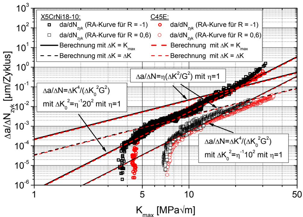
**Abbildung 5.4-4: Analyse der Ansätze von Weertman zur Beschreibung der zyklischen Rissausbreitung**
