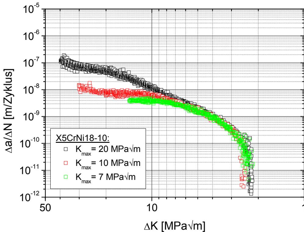
Abbildung 4.1-5: Rissausbreitungskurven der alternativen Schwellenwertermittlung von X5CrNi18-10 ( $\Delta a/\Delta N$  über  $\Delta K$ )
