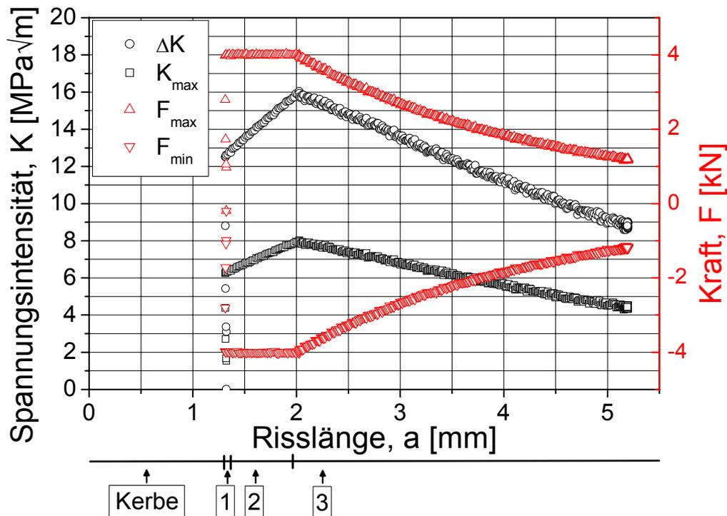
Abbildung 3.2-5: Versuchsregelung nach der Load-Shedding Methode
