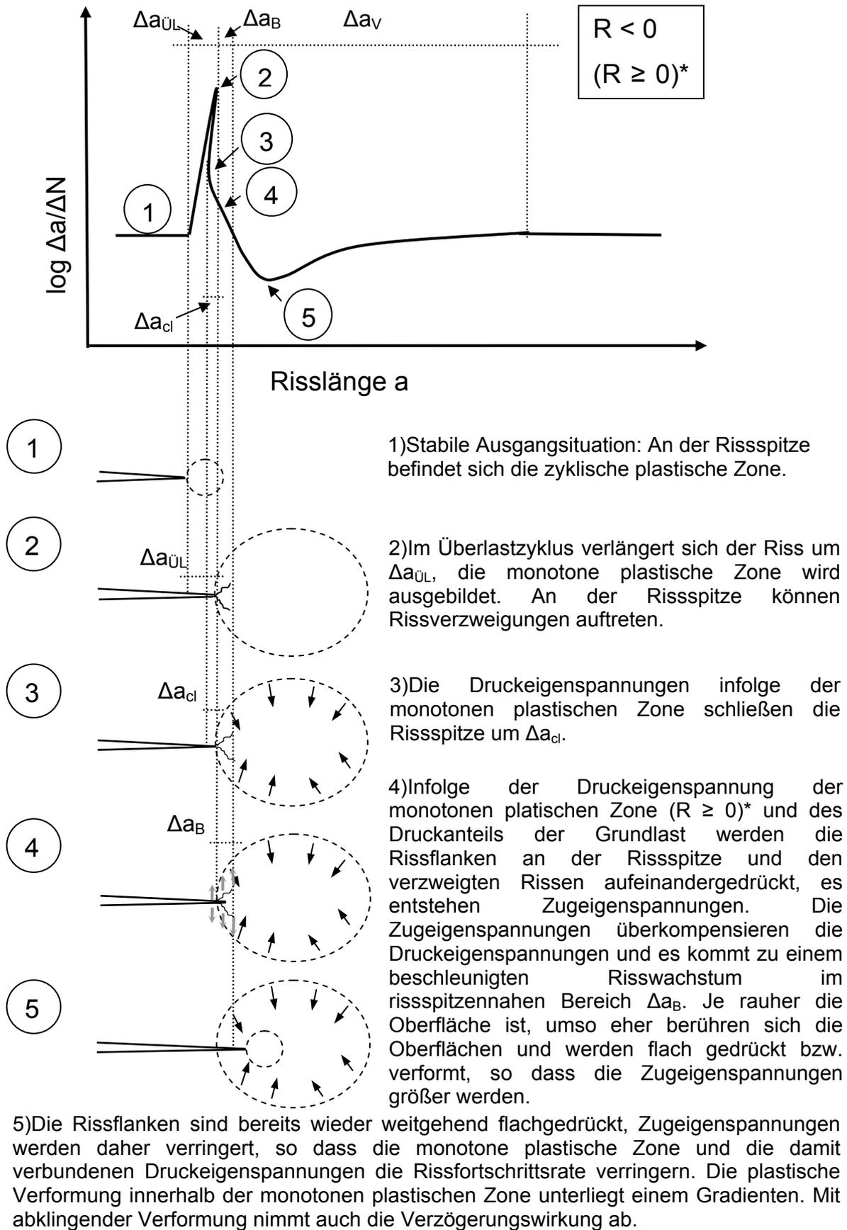
**Abbildung 5.4-5: Modellvorstellung für den Einfluss von Überlasten unter Berücksichtigung einer Beschleunigung der Rissfortschrittsrate nach der Überlast**
