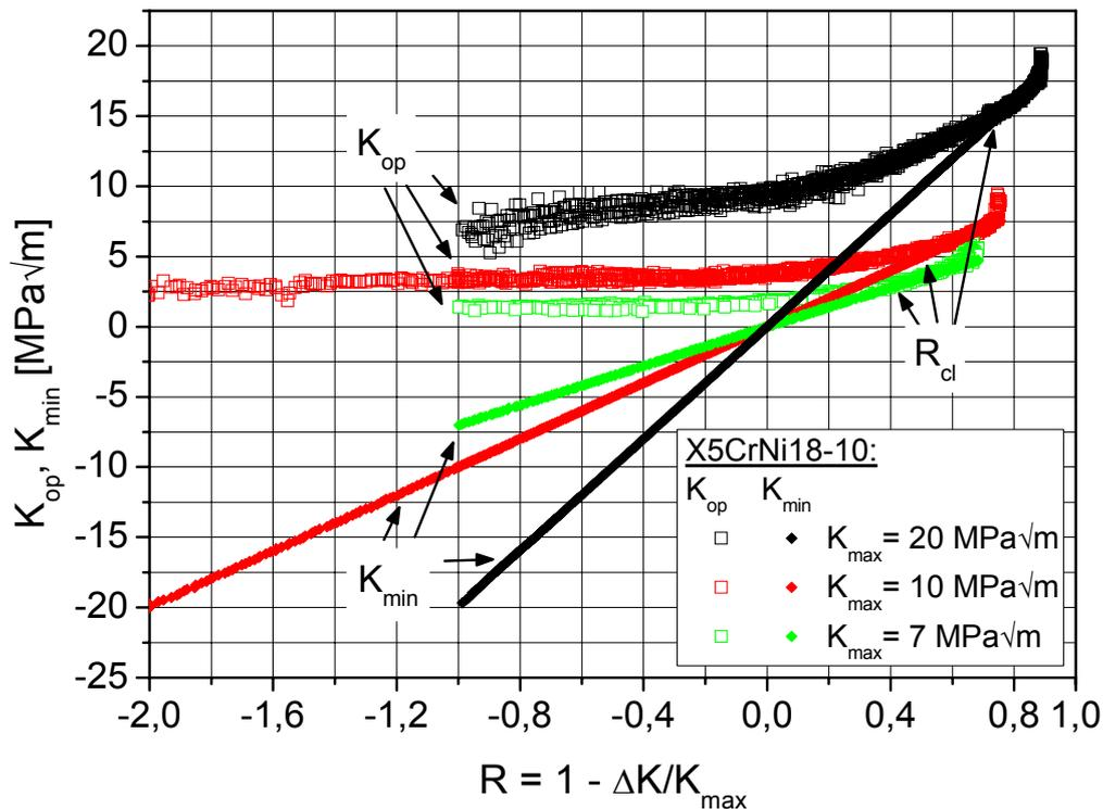
**Abbildung 5.2-8:  $K_{op}$  aus den Experimenten berechnet und anliegendes  $K_{min}$  über R**
