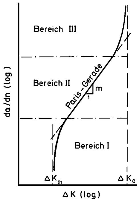
**Abbildung 2.2-2: Schematischer Verlauf der Rissausbreitungskurve (nach [Haibach'89])**
