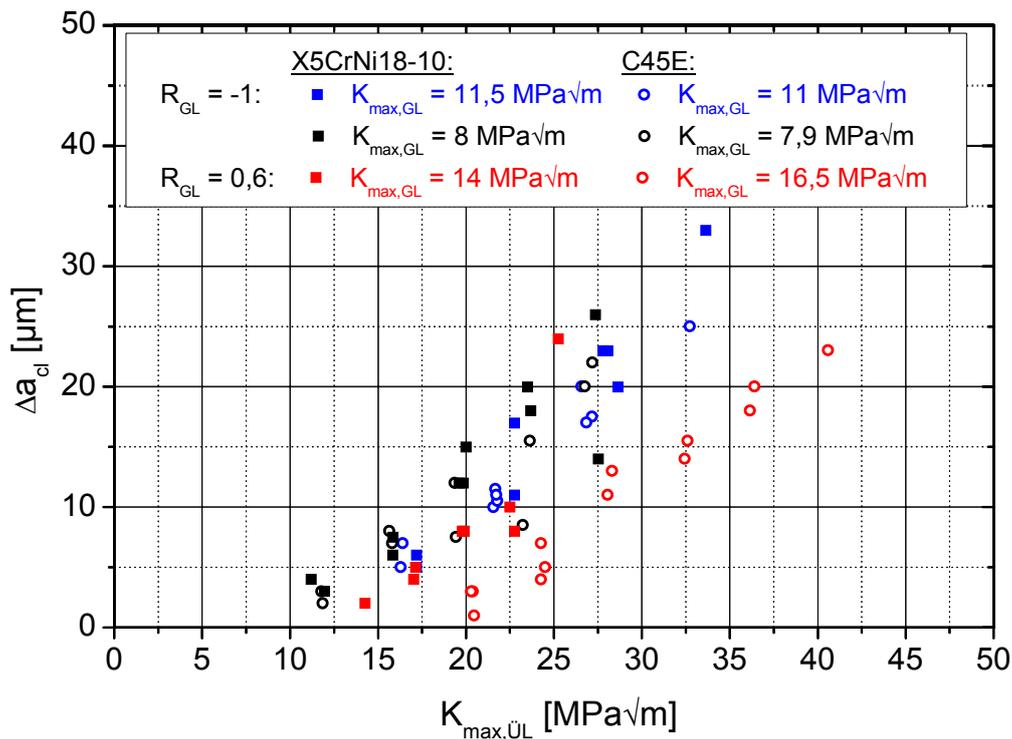
**Abbildung 4.2-5: Einfluss von Überlasthöhe,  $K_{\max, GL}$  und  $R_{GL}$ -Wert auf  $\Delta a_{cl}$  im X5CrNi18-10 und C45E**
