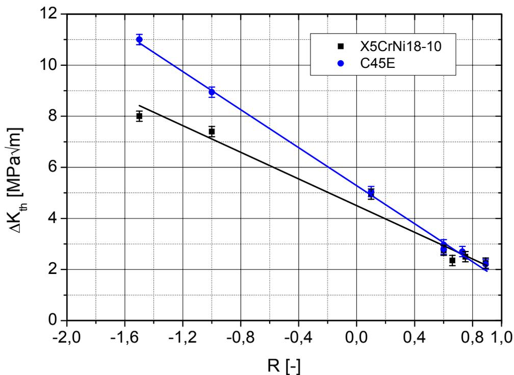
Abbildung 4.1-9: Schwellenwerte  $\Delta K_{th}$  der Stähle C45E und X5CrNi18-10 in Abhängigkeit vom R-Wert
