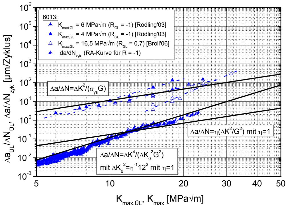
**Abbildung 5.4-3: Vergleich der berechneten Rissfortschrittsrate mit  $\Delta a_{\text{ÜL}}$  und der zyklischen Rissfortschrittsrate beim 6013**
