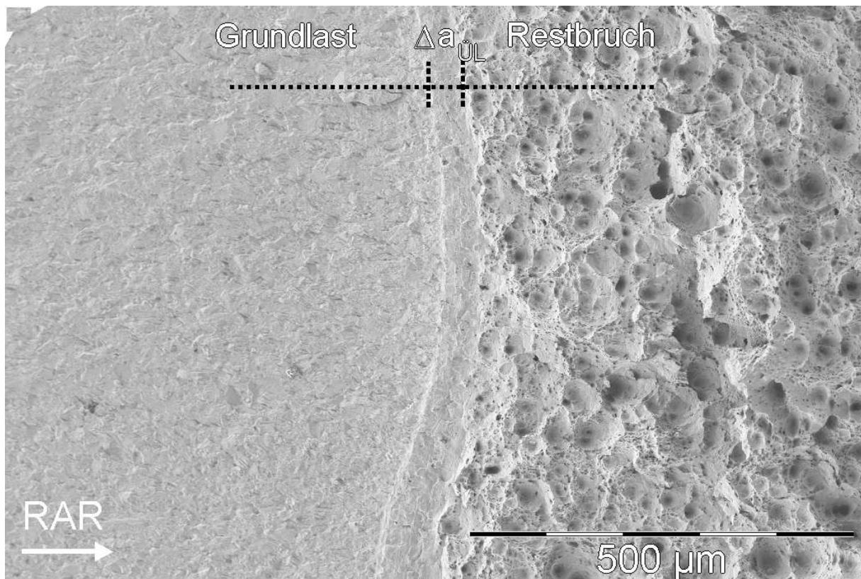
**Abbildung 4.2-16: Übergang Grundlast –  $\Delta a_{\text{ÜL}}$  – Restbruch im X5CrNi18-10**
