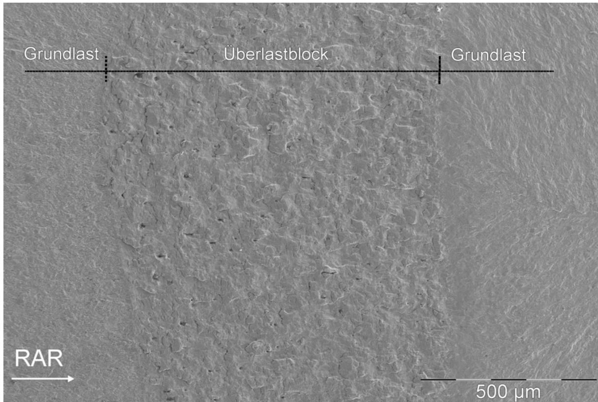
**Abbildung 4.2-18: Bereich der Rissverlängerung während eines Zug-/Druck-Überlastbockes im X5CrNi18-10**
