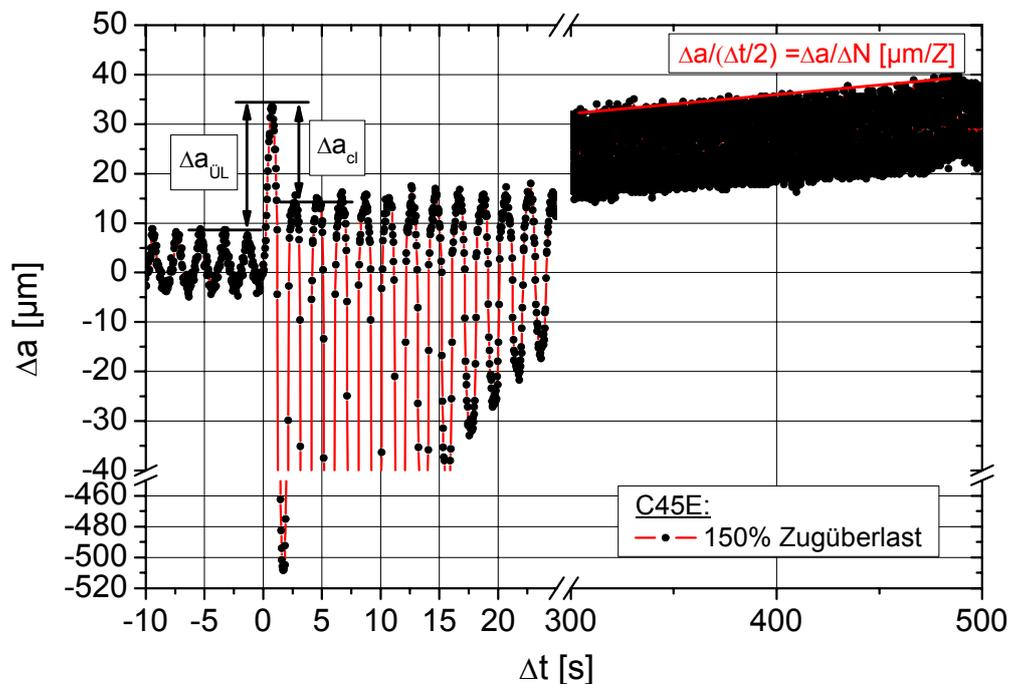
**Abbildung 4.2-2: Auswertung des Potentialsignals des Rechners Erika II**
