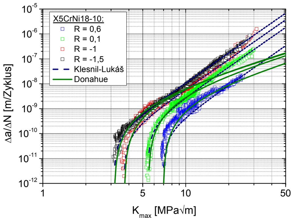
Abbildung 4.1-7: Anpassung von Rissfortschrittsgesetzen an die Rissausbreitungskurven von X5CrNi18-10
