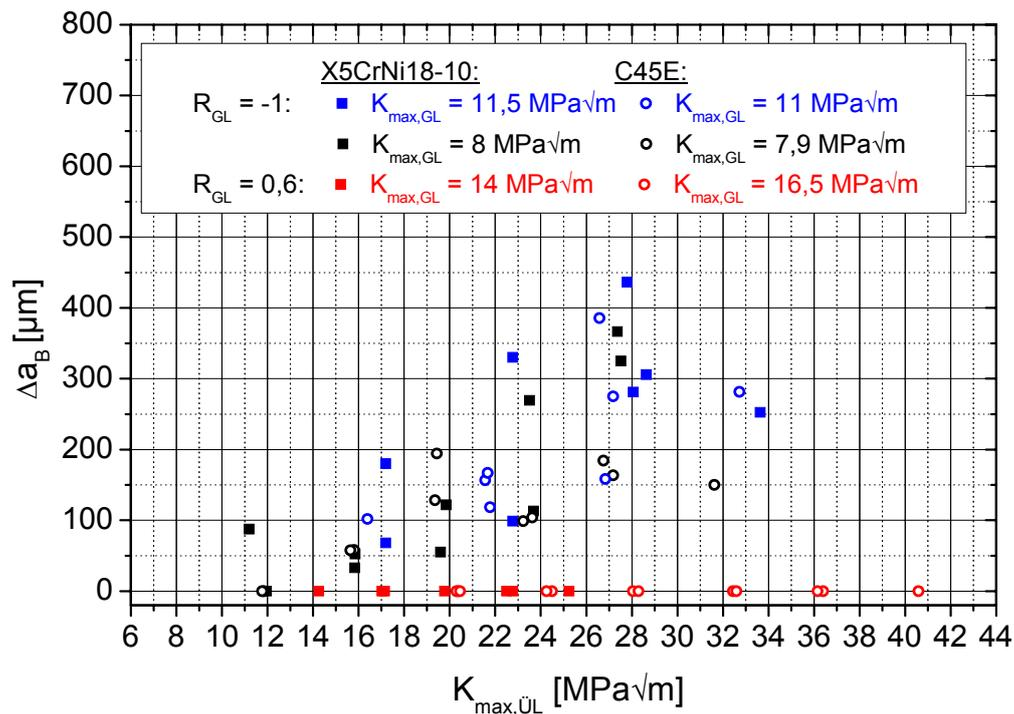
Abbildung 4.2-6: Einfluss von Überlasthöhe,  $K_{max,GL}$  und  $R_{GL}$ -Wert auf  $\Delta a_B$  im X5CrNi18-10 und C45E
