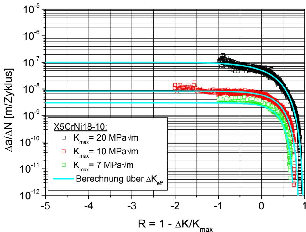
**Abbildung 5.3-5: Berechnung der Rissausbreitungskurven der alternativen Schwellenwertmessung über  $\Delta K_{\text{eff}}$**
