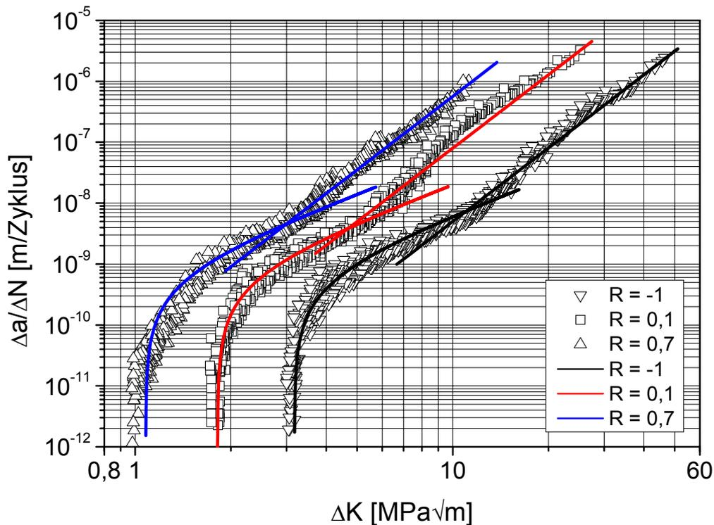
**Abbildung 2.2-9: Experimentelle und berechnete Rissausbreitungskurven bei unterschiedlichen R-Werten des Aluminiums 6013 [Rödling'03]**
