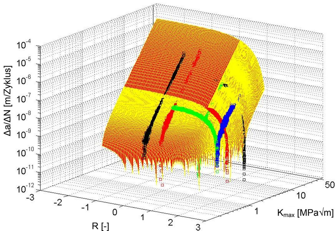
Abbildung 5.3-6: 3D-Darstellung der berechneten Rissfortschrittsrate  $\frac{da}{dN}(R, K_{\max})$  und der Rissausbreitungskurven vom X5CrNi18-10
