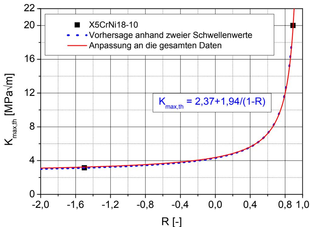
Abbildung 5.3-1: Anpassung der Funktion  $K_{\max,th}(R)$  (5.2-4) an die zwei Schwellenwerte
