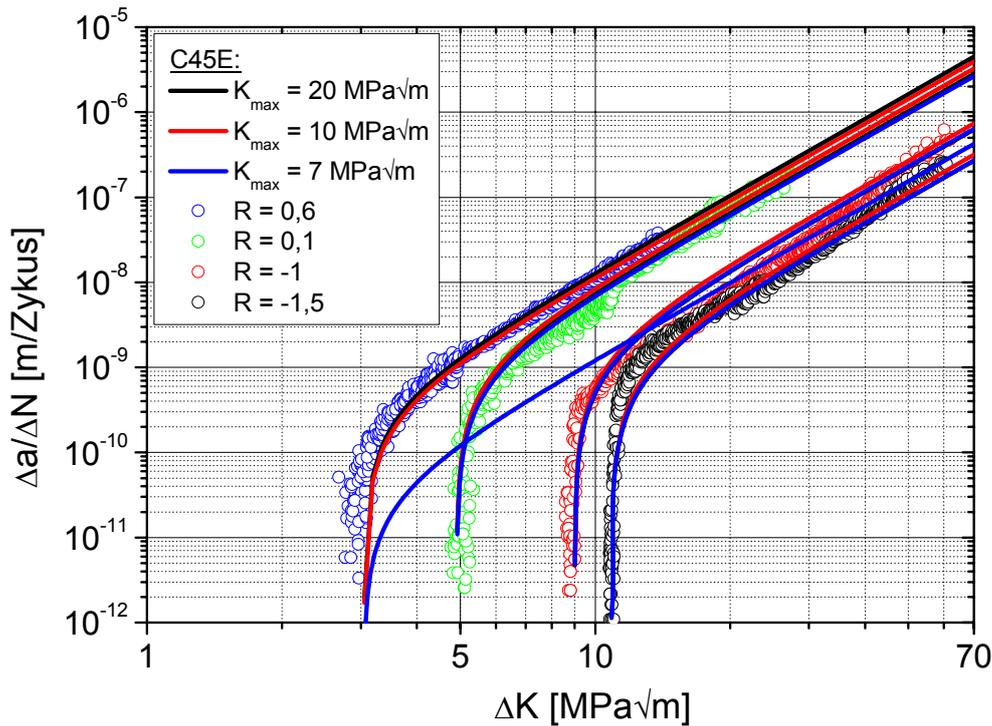
**Abbildung 4.1-12: Berechnete Rissausbreitungskurven über die Funktion von Rödling**
