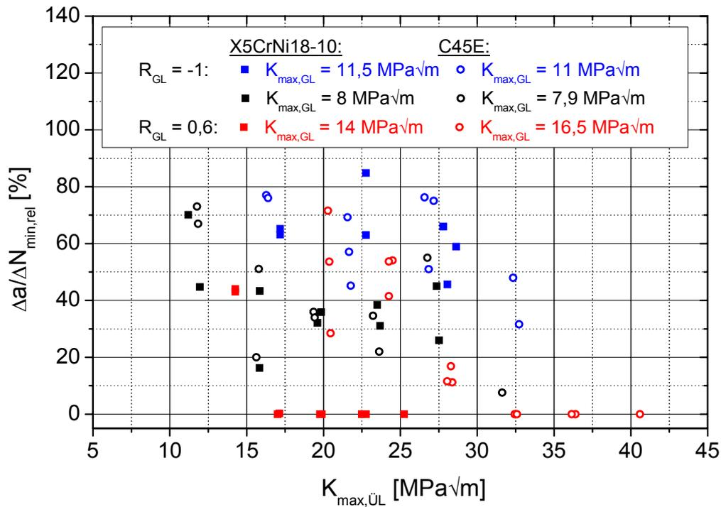
Abbildung 4.2-7: Einfluss von Überlasthöhe,  $K_{max,GL}$  und  $R_{GL}$ -Wert auf die relative minimale Rissfortschrittsrate im X5CrNi18-10 und C45E
