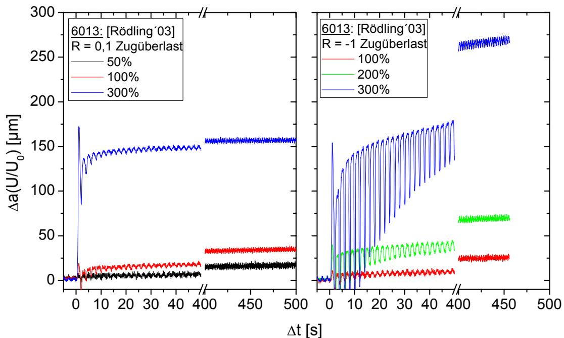
**Abbildung 5.4-7: Potentialsignale Rechner Erika II; Vergleich von  $R_{GL} = 0,1$  mit  $R_{GL} = -1$  im 6013**
