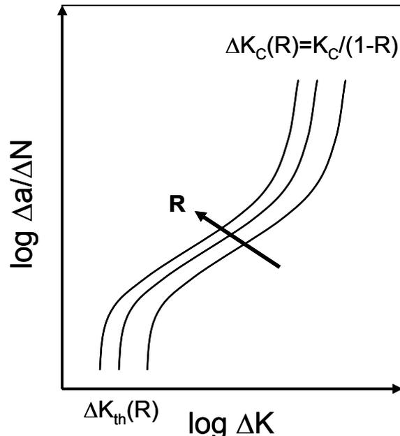
**Abbildung 2.2-3: Schematische Darstellung vom Einfluss von R auf die Rissausbreitung**
