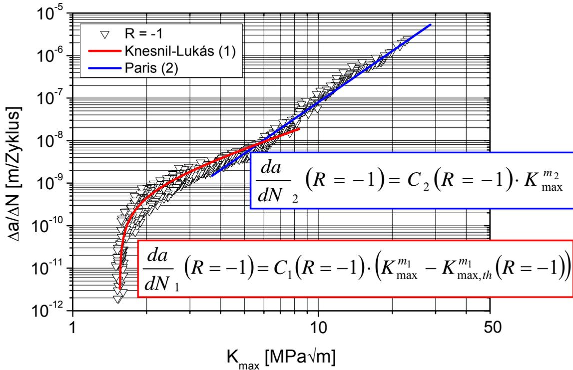
**Abbildung 2.2-7: Rissausbreitungskurve ( $R = -1$ ) für die Aluminiumlegierung 6013 und die Ermittlung der Parameter der Rissfortschrittsgesetze [Rödling'03]**
