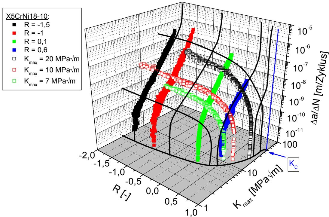
**Abbildung 5.2-3: Erweiterte 3D-Darstellung der Rissausbreitungsexperimente**
