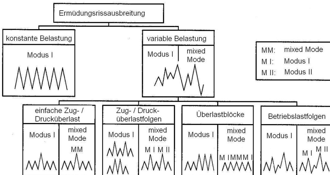
**Abbildung 2.2-10: Variationsmöglichkeiten mechanischer Lastfolgen nach [Sander'06]**
