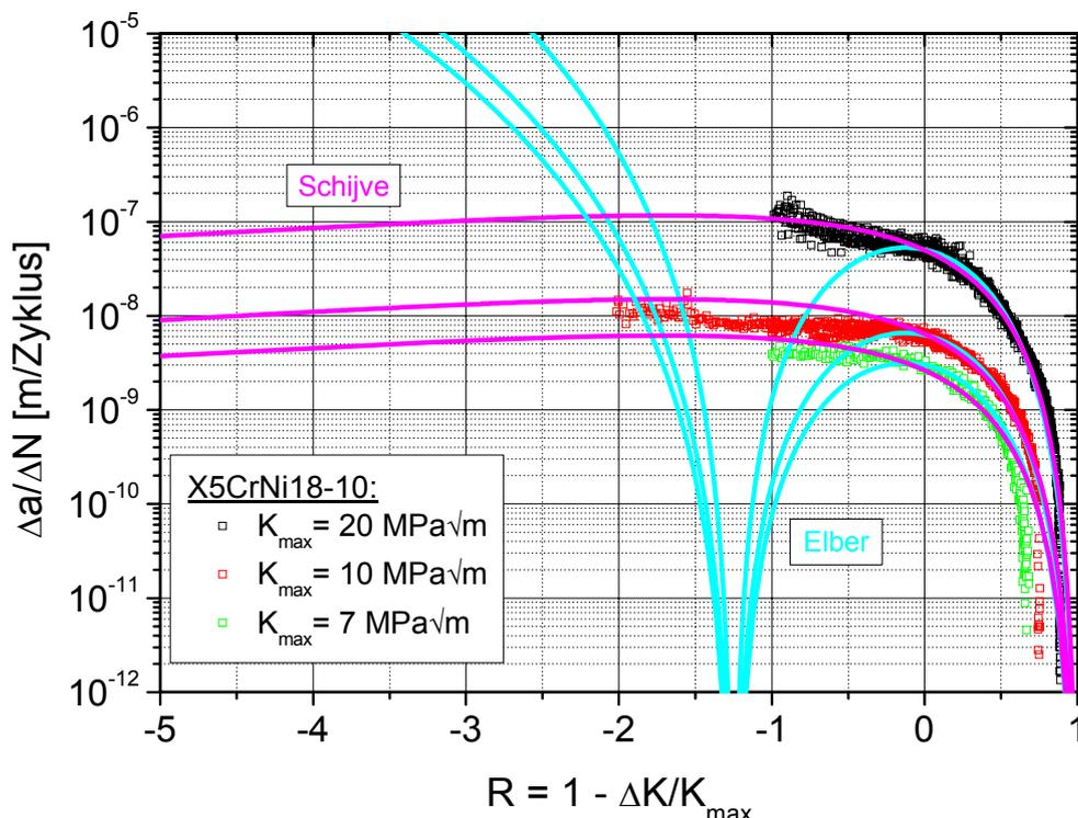
Abbildung 5.1-3: Anpassungen der Experimente der alternativen Schwellenwertermittlung über die Funktion (5.1-2)
