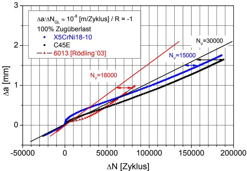
**Abbildung 4.2-21: Vergleich Stahl und Aluminium - Rissverlängerung infolge einfacher Zugüberlast über der Zyklenzahl**
