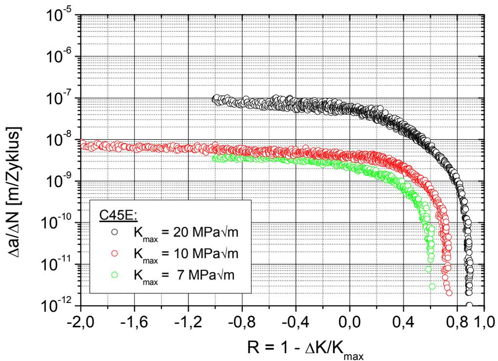
Abbildung 4.1-4: Rissausbreitungskurven der alternativen Schwellenwertermittlung von C45E ( $\Delta a/\Delta N$  über R)
