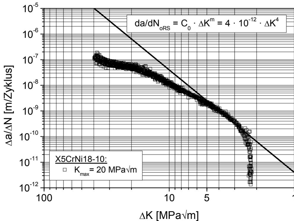
**Abbildung 5.3-3: Ermittlung von  $C_0$  anhand der alternativen Schwellenwertmessung**
