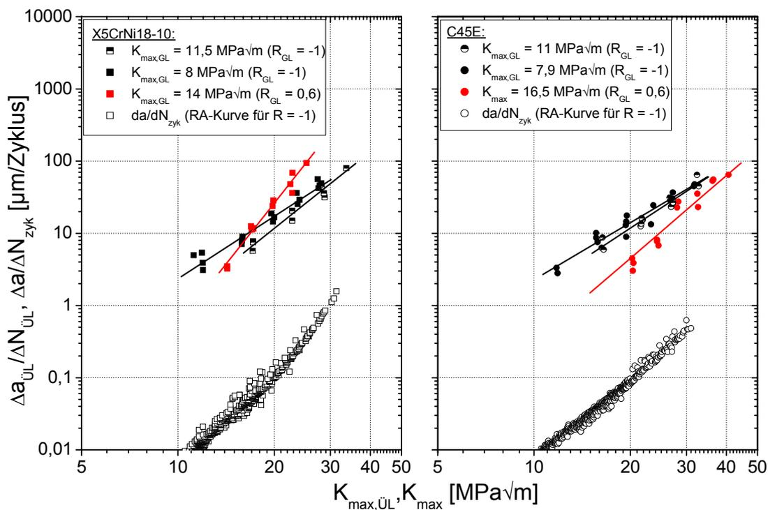
Abbildung 4.2-14: Vergleich von  $\Delta a_{\text{ÜL}}$  mit  $\frac{da}{dN_{\text{zyk}}}$  im X5CrNi18-10 und im C45E
