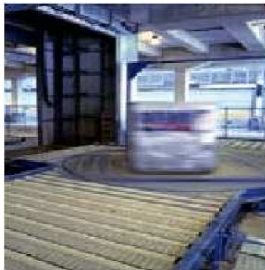
Abbildung 2.6: Rollenband mit Drehtisch der Firma Lödige auf dem Flughafen Frankfurt
