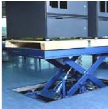
Abbildung 2.11: Eckumsetzer der Firma Lödige mit vorausgehender Ausrichter- strecke auf Hebebühne montiert
