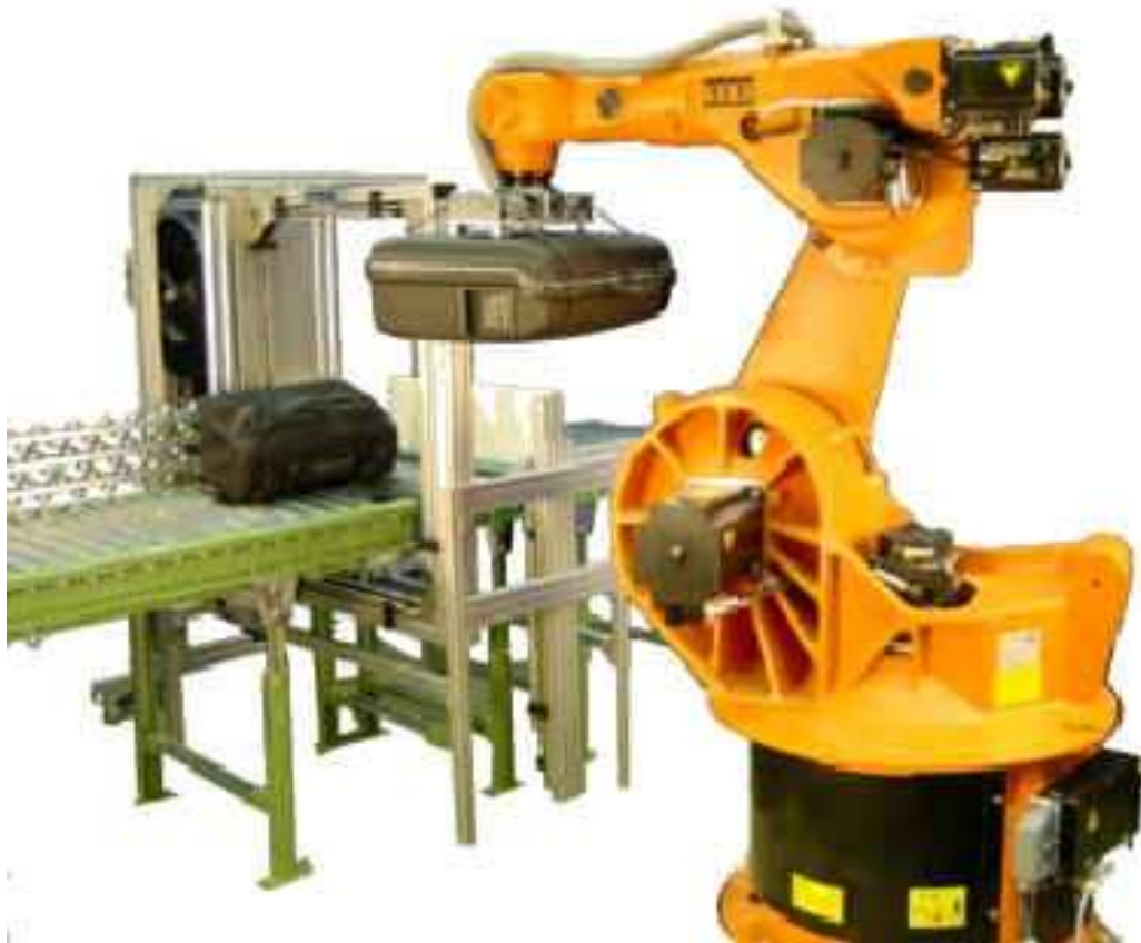
Abbildung 2.4: Pilotanlage der Fa. Grenzebach
