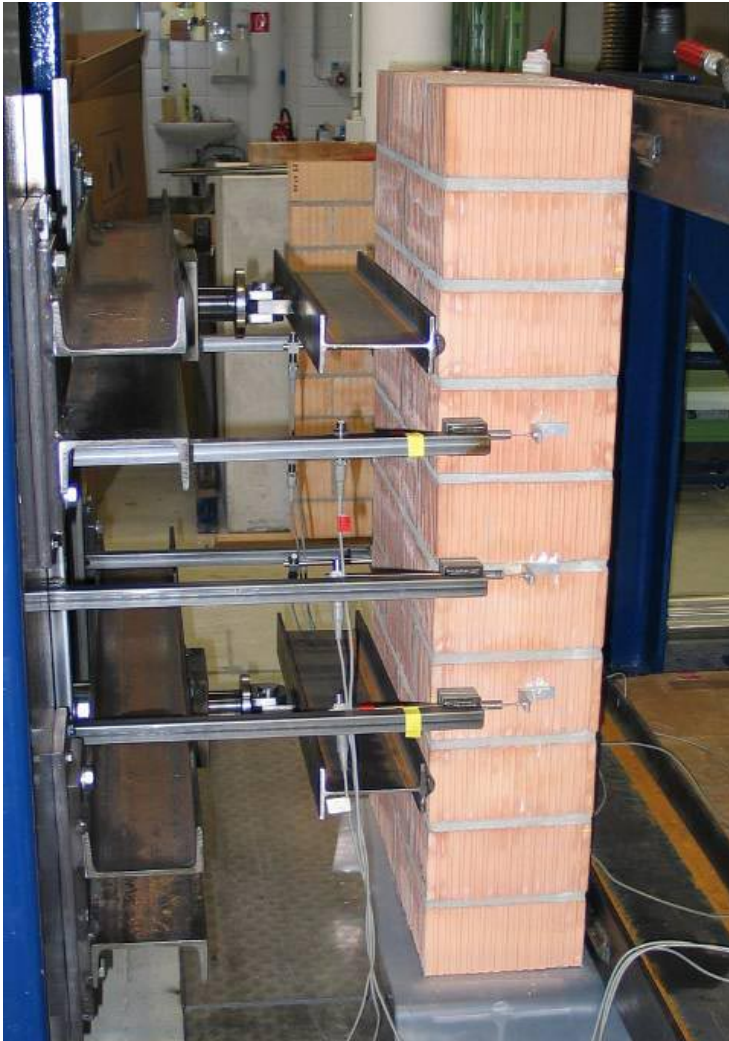
Abbildung 3.2: Eingebauter Prüfkörper vor der Vier-Punkt-Biegeprüfung mit Darstellung der Verformungsmessung.
