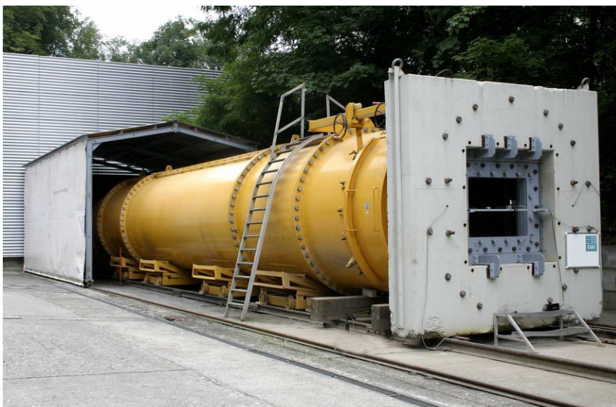
Abbildung 4.1: Prinzipskizze und Abbildung des Stoßrohrs mit einem Objektträger aus Stahlbeton und einem Metallprüfrahmen zur Prüfung von Sicherheitssonderverglasung.
