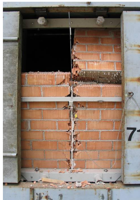
Abbildung 11.23: Versagter, unverstärkter Mauerwerkskörper (MD-W3) und verstärkter Prüfkörper (MD1-W7) nach Stoßrohrprüfung.
