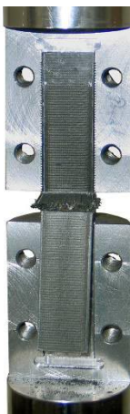
Abbildung 2.8: Druckversuch einer CFK-Lamelle und Darstellung der Druckschädigung.
