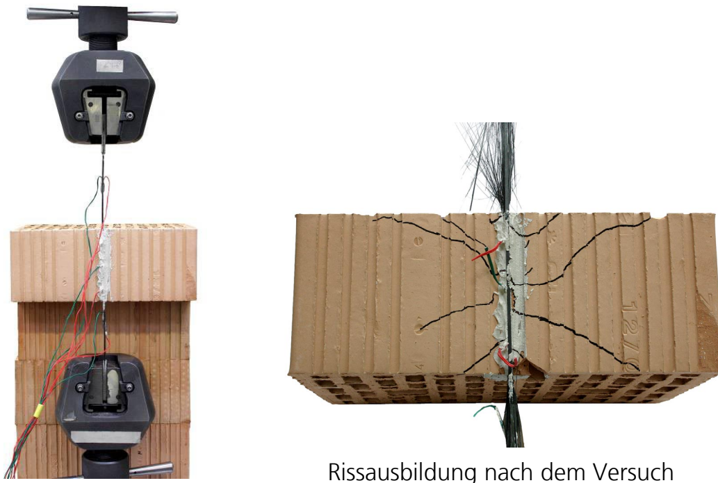
Abbildung 3.24: Versuchsaufbau zur Untersuchung der Verbundwirkung und Prüfkörper mit Rissbild nach dem Versuch.
