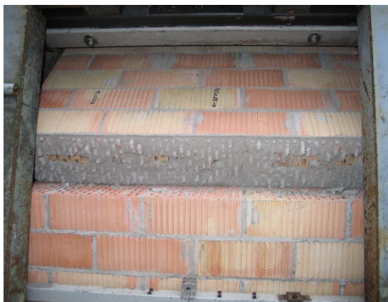
Versuch MS-W3; (ohne CFK-Lamelle)
