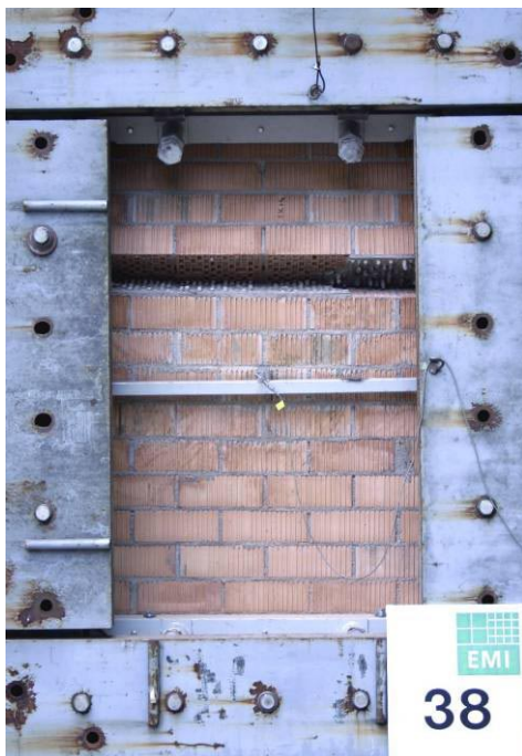
Abbildung 11.23: Versagter, unverstärkter Mauerwerkskörper (MD-W3) und verstärkter Prüfkörper (MD1-W7) nach Stoßrohrprüfung.
