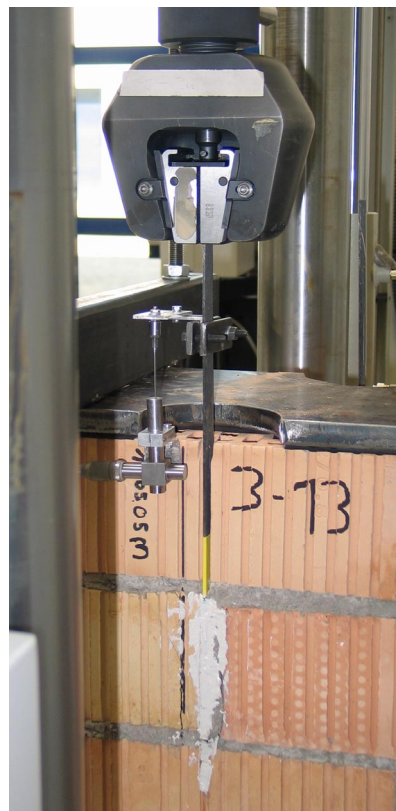
Abbildung 3.16: Versuchsaufbau eines Zug-Druck-Verbundversuchs am Beispiel des Versuchs AH3-13 mit einer Verankerungslänge von 113 mm (entspricht einer Steinhöhe ohne Lagerfuge).
