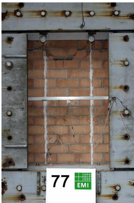
Abbildung 11.24: Versagter Prüfkörper MD2-W9 mit zwei CFK-Lamellen nach der Stoßrohrprüfung.
