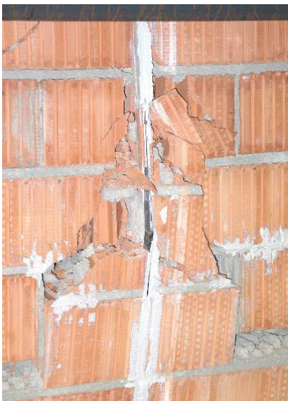
Abbildung 3.4: Versagen einer Lagerfuge mit keilförmiger Bruchflächen im Endverankerungsbereich für den Versuch MS1T-1 mit einer CFK-Lamelle.
